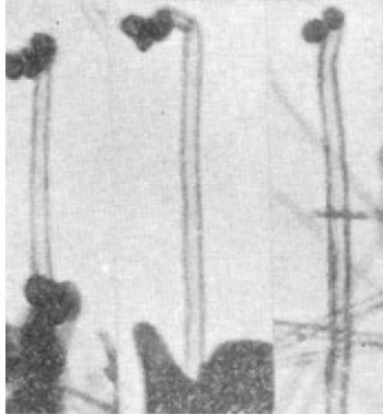
Figura 1.5. Primeras imágenes TEM de los nanotubos de Carbono de pared múltiple. Tomado de la Ref. 34.
