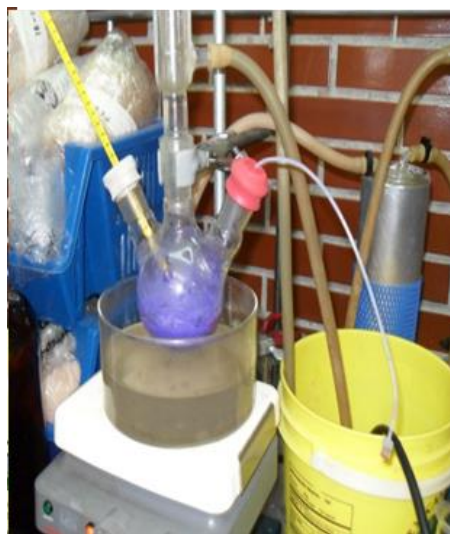
Figura A2. a) Preparación del estearato de cobalto. b) Preparación del estearato de manganeso.
