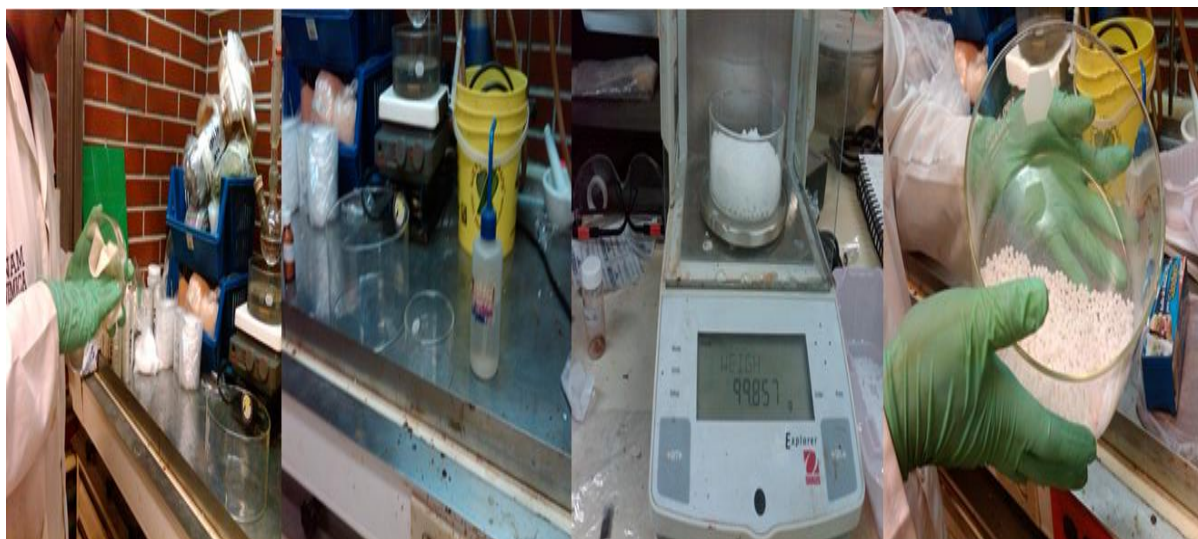
a) b) c) d) Figura B1. Mezcla de aditivo pro-oxidante con los pellets 20020X. a) y b) Lavado del recipiente con acetona. c) Pesaje de pellets y d) mezclado del aditivo con los pellets.
