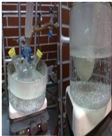
Figura A2. a) Preparación del estearato de cobalto. b) Preparación del estearato de manganeso.
