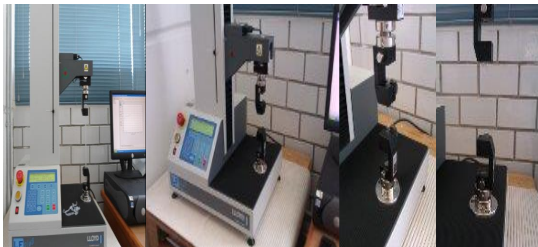
Figura C1. Máquina de ensayo universal Modelo Lloyd LFPlus 1 kN (225 lbf). UAM Azcapotzalco.
