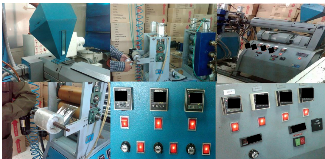
Figura B2. Extrusor mono-husillo. Fabricación de películas de polietileno con y sin aditivo pro-oxidante.
