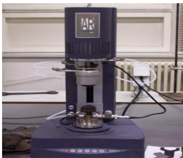
Figura C4. Reómetro AR-2000 marca TA-Instruments. Instituto de Investigaciones en Materiales, UNAM.
