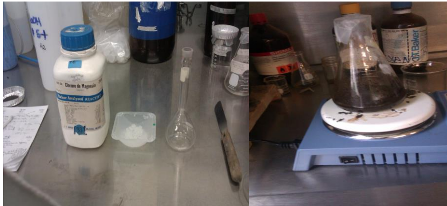
Figura E5. a) Fracción soluble, muestra mezclada con MgCl_2 , b) Fracción asociada a carbonatos.
