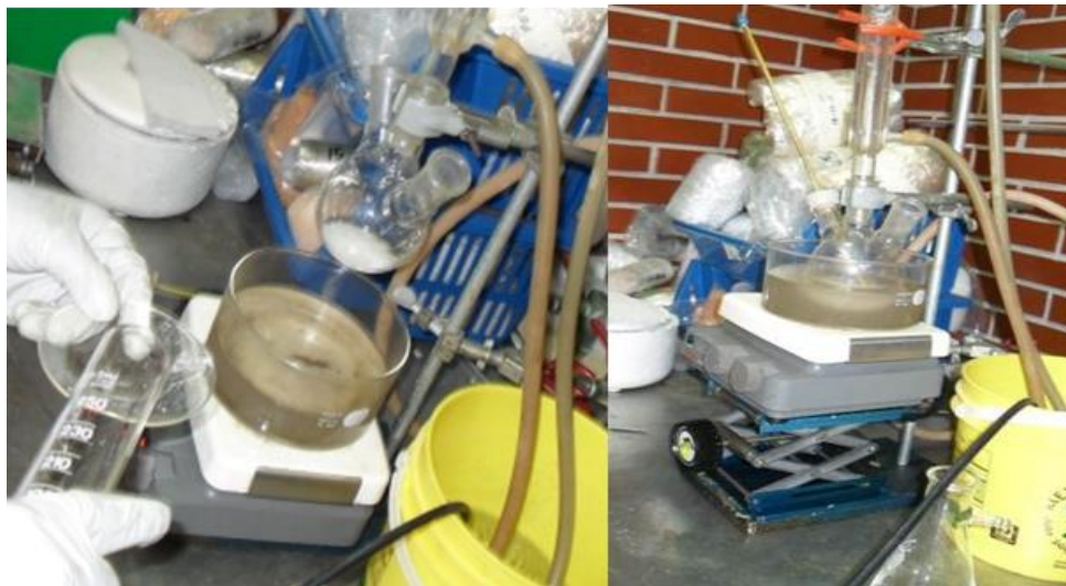
Figura A1. Preparación del estearato de sodio
