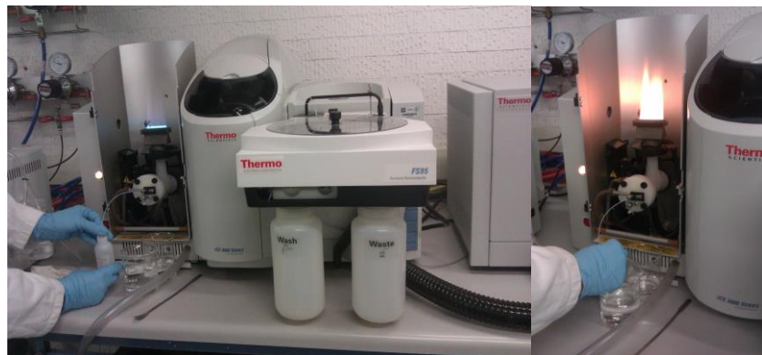
Figura E1. Equipo de absorción atómica. Laboratorio de Ingeniería Ambiental del Instituto de Ingeniería.
