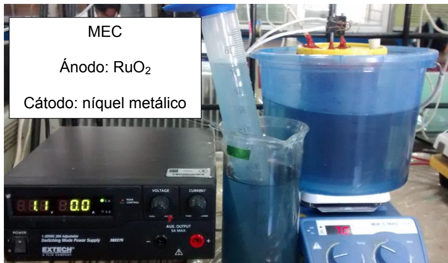
Figura 19. Celda Microbiana de Electrólisis: celda (derecha), probeta invertida para medición de gas (en medio) y fuente de poder (izquierda).
