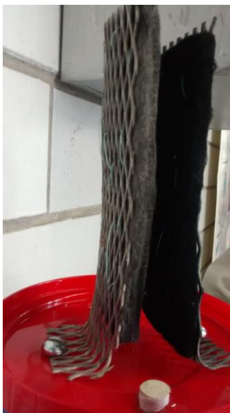
Figura 17. Electroodos montados en la tapa del reactor, con 5 cm de separación.
