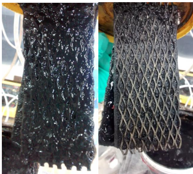
Figura 20. Biopelícula formada en el ánodo (izquierda) y en el cátodo (derecha).
