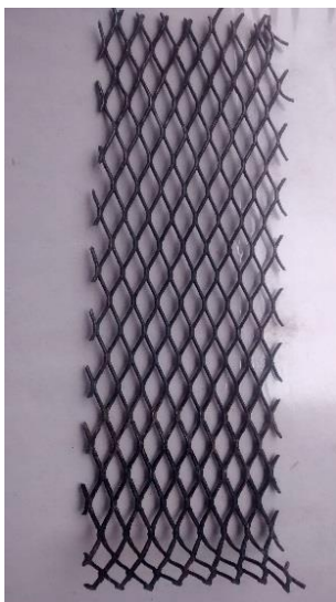
Figura 14. Malla de titanio usada como soporte.
