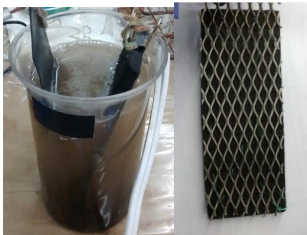
Figura 15. Electrodeposición de cloruro de rutenio (izquierda) y fibra de carbono cocida a la malla de titanio, ambas recubiertas con RuO 2 (derecha).
