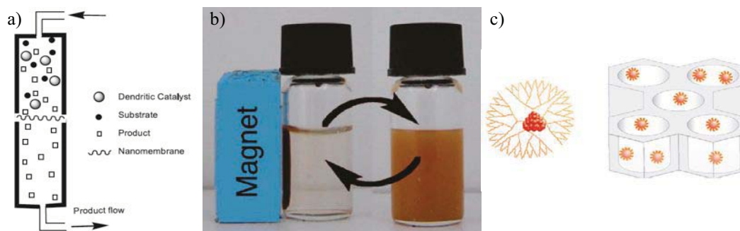
Figura 2.41. Métodos de recuperación usados para el reciclaje de compósitos nanopartícula-dendrímero: (a) nanofiltración, (b) recuperación magnética, (c) depósitos en el interior de estructuras mesoporosas.
