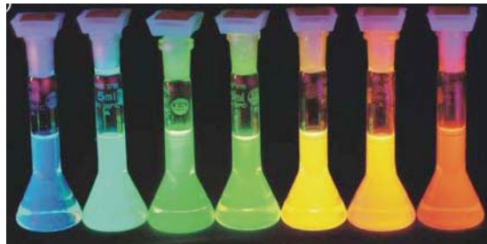
Figura 2.09. Fluorescencia de coloides de nanopartículas “core-shell” de CdSe-CdS. El color indica un tamaño promedio creciente, ya que el primer matraz (en azul), contiene nanopartículas con tamaños promedio de 1.7 nm, en tanto las últimas tienen un tamaño de 6 nm (rojo).
