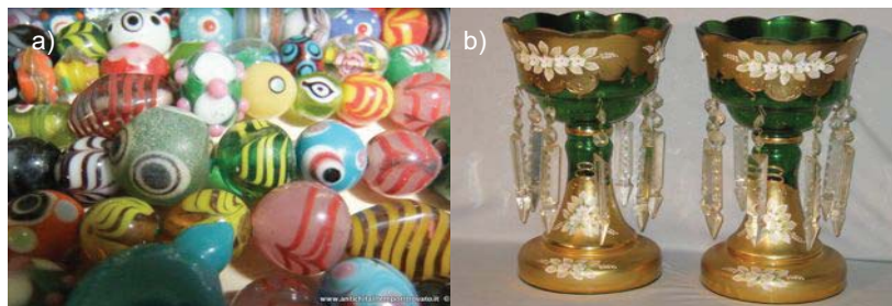
Figura 2.02. (a) Vidrio de Murano (región del Véneto, Italia) y (b) vidrio de Bohemia. Ambos son ejemplos de nanopartículas de óxidos de metales de transición sintetizados en matrices de vidrios.
