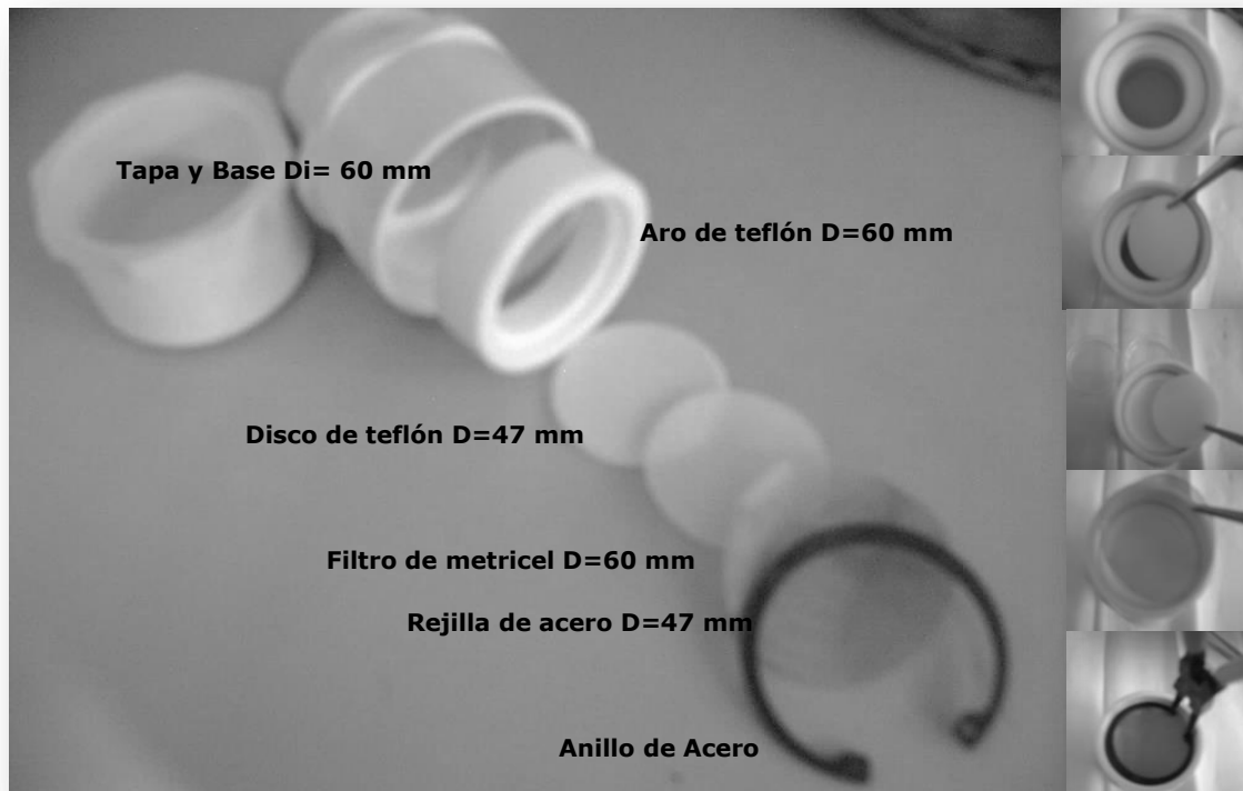
Figura 3.1-1 Captadores pasivos: Componentes y armado.
