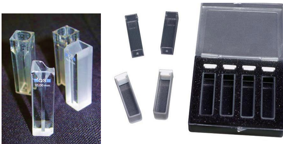
Figura 2.9-2 Cubetas de espectrofotometría. En un primer plano, dos de cuarzo aptas para el trabajo con luz ultravioleta; en segundo plano, de plástico, para colorimetría ( es decir, empleando luz visible ). Del lado derecho se muestran cubetas en su estuche
