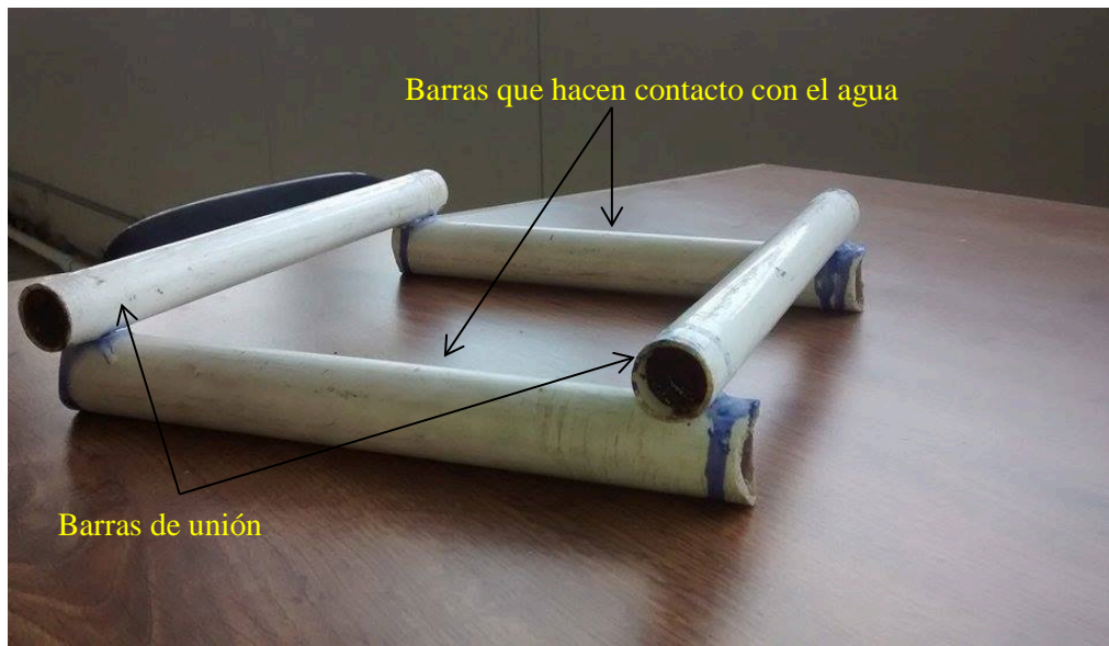
Figura 3.20.- Detalle de flotador “balsa”
