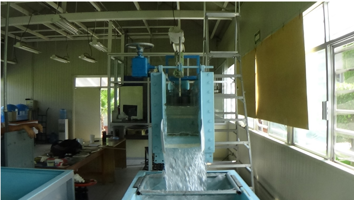
Figura 3.22.- Canal con vertedor en funcionamiento
