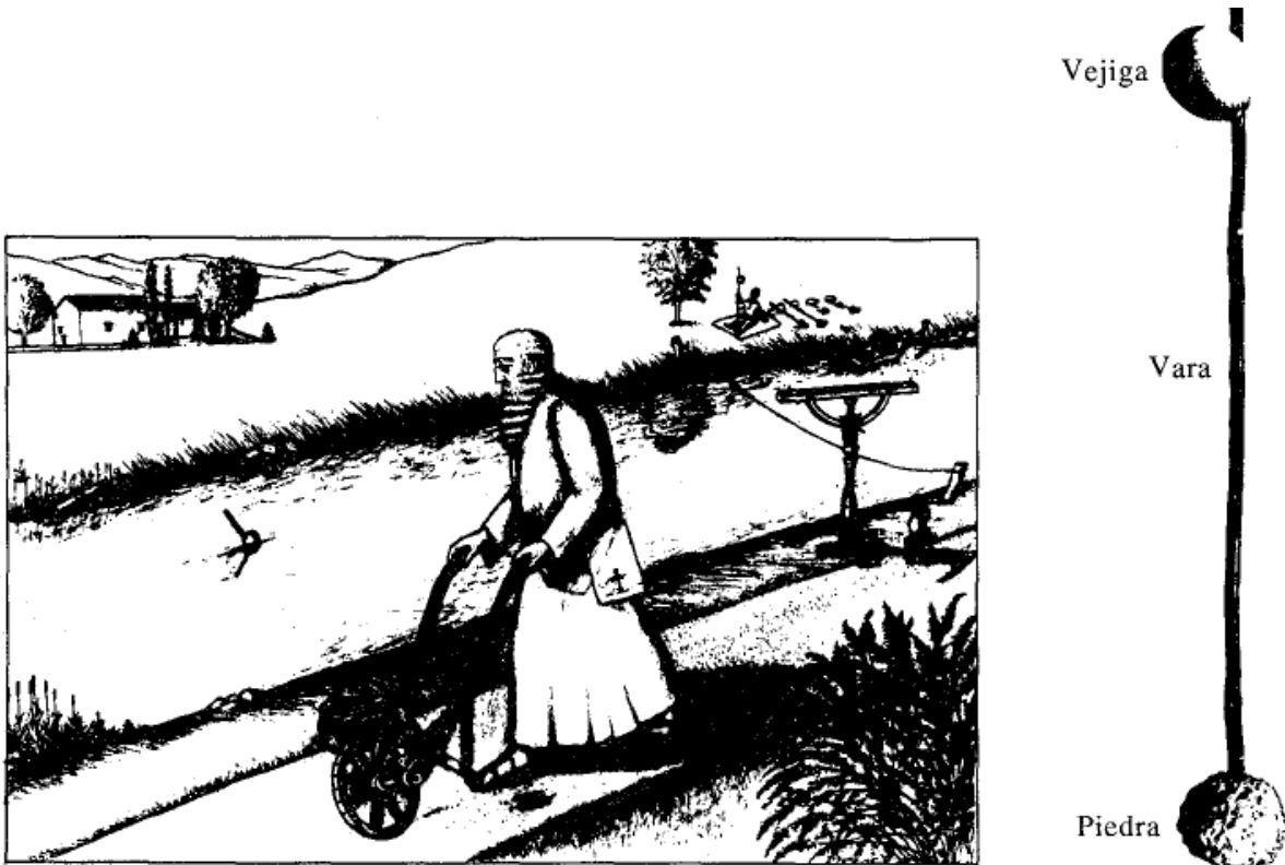
Figura 2.1. -Representación de Da Vinci realizando mediciones de velocidad en una corriente utilizando un flotador (izquierda), a la derecha se presenta un esquema del flotador utilizado, tomado de Chow (1994)
