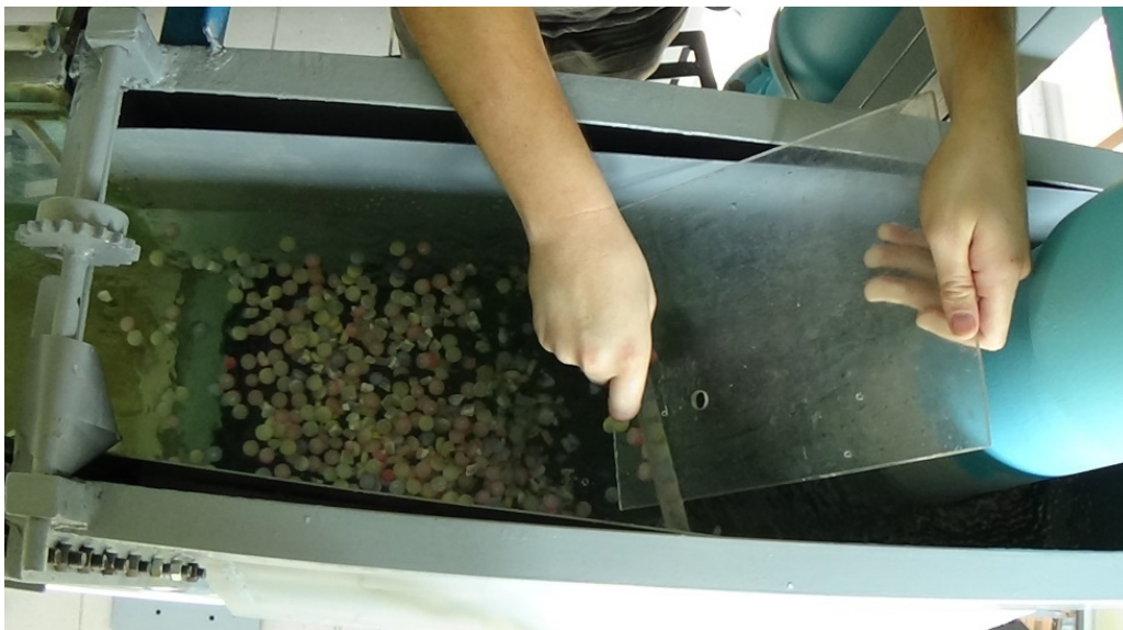
Figura 3.19.- “Lentejas” de cera empleadas para mediciones de LSPIV .
