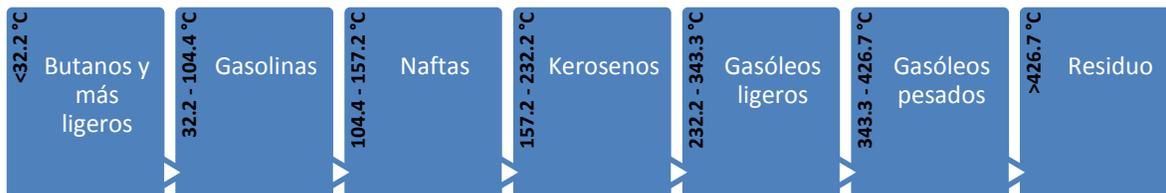
Esquema 1. Fracciones de destilación del petróleo crudo por intervalos de temperatura.
