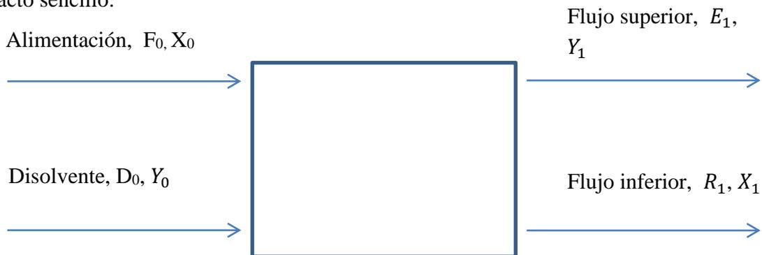
Figura 1.3. Diagrama representativo para una etapa de extracción, con los diferentes flujos y condiciones (Ibarz y Cánovas, 2005)
