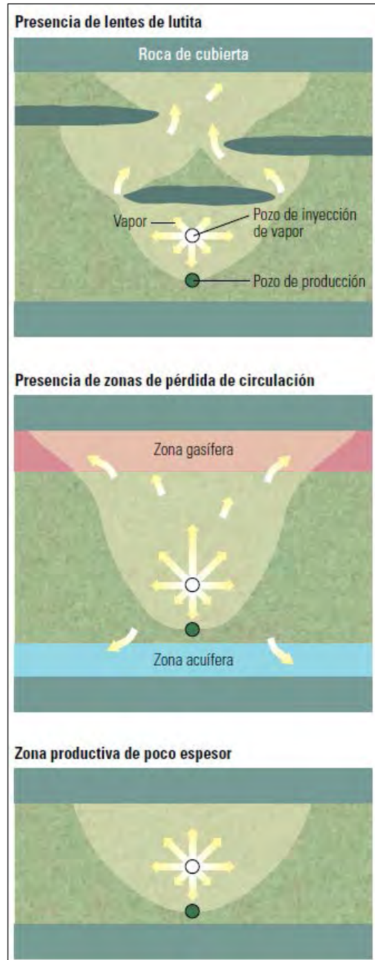
Figura VI.1 – Características de un yacimiento el cual no cumple con los requerimientos mínimos para aplicar este método SAGD (Schlumberger, 2014)
