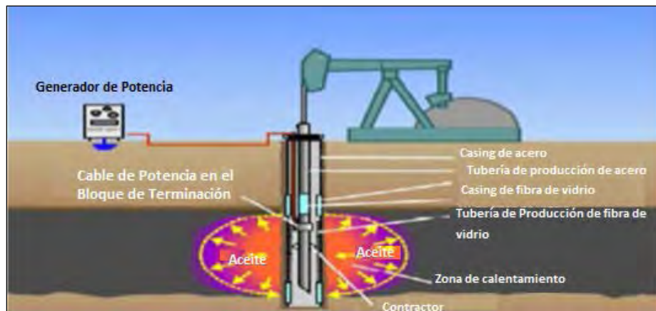
Figura V.24 – Calentamiento eléctrico de baja frecuencia de un pozo vertical (Sierra, SPE 2001)
