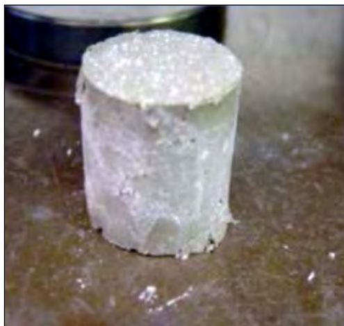
Figura VI.11 – Aditivo expansivo que ayuda a mejorar la adherencia del cemento (Ramírez-Vázquez SPE, 2014)
