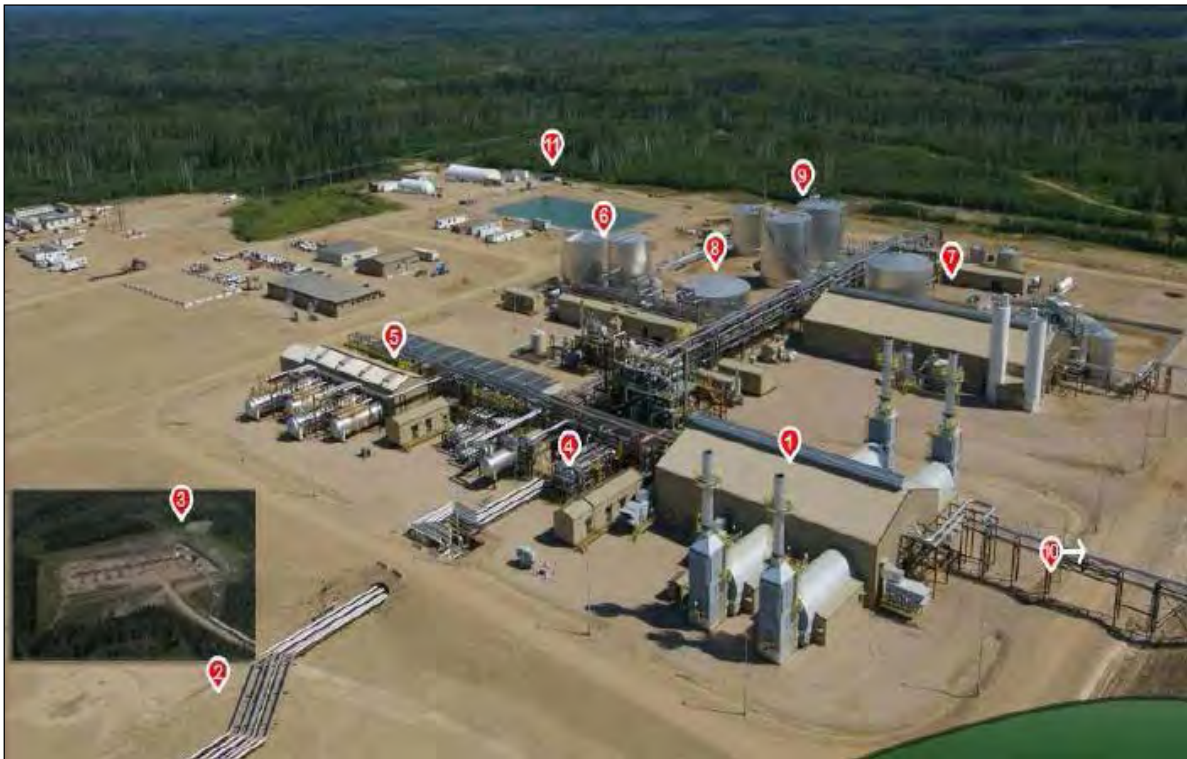
Figura V.6 – Instalaciones requeridas para el SAGD (Conoco Phillips, 2015)
