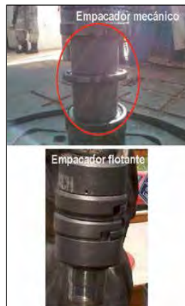
Figura VI.20 - Empacadores utilizados en la prueba piloto (Arteaga Cardona Marcela, agosto 2013)
