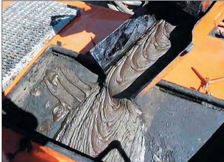
Figura V.29 – Lechada producida por el método de producción de petróleo pesado en frío con arena (CHOPS) (Schlumberger, 2006)
