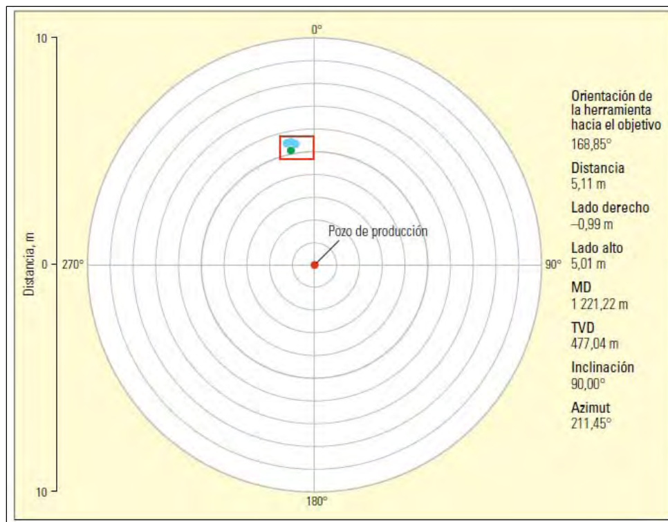
Figura VI.2 – Mediciones de la separación relativa entre pozos (Schlumberger, 2014)
