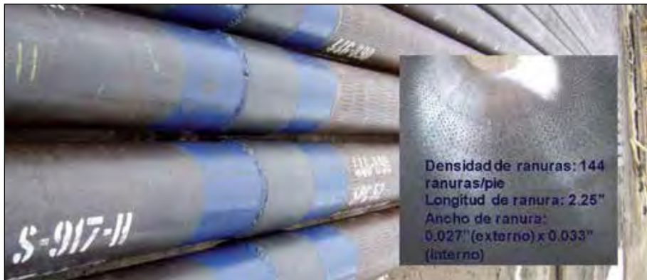
Figura VI.18 – Tubería ranurada utilizada para el control de producción de arena (Arteaga Cardona Marcela, agosto 2013)
