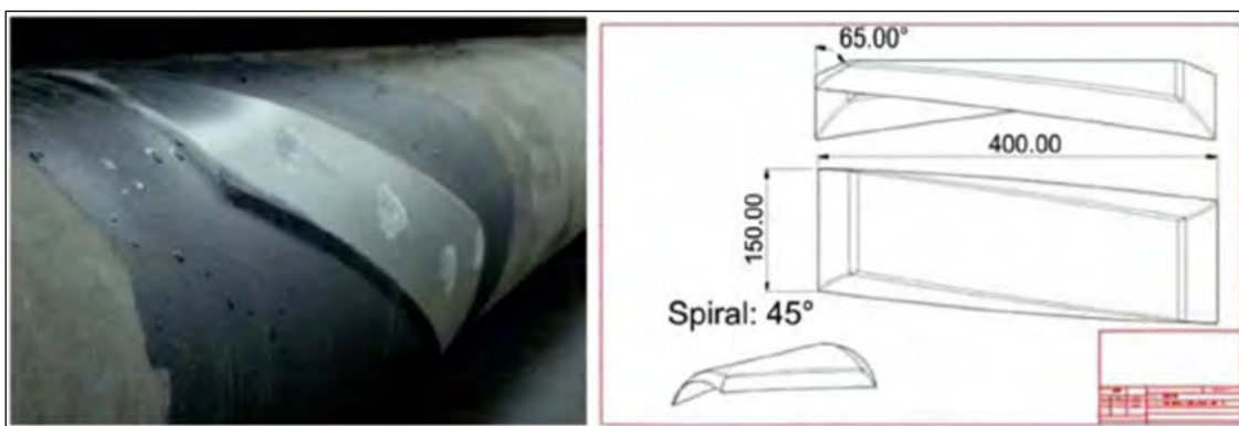
Figura VI.10 – Configuración de un centrador a base de lodo utilizada en pozos horizontales de inyección de vapor (Ramírez-Vázquez SPE, 2014)
