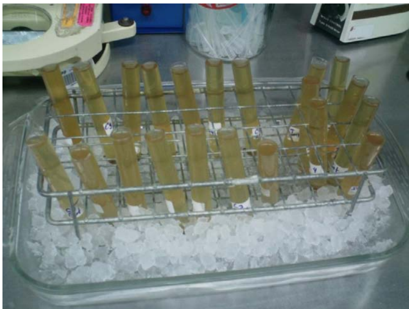
Figura 11. Tubos en los que se depositó el líquido extraído de los embudos de Baermann sobre una charola de cristal con hielo para mantener las larvas en el fondo del tubo y evitar que se pierdan al momento de retirar sobrenadante.
