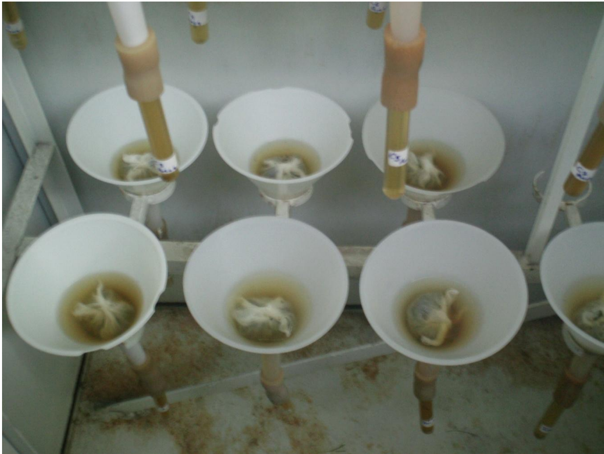
Fig 10. Embudos de Baermann en los que se depositaron las suspensiones obtenidas de los grupos control y confrontación entre Ancylostoma caninum y Butlerius sp al término de los 25 días, con la finalidad de realizar una concentración larvaria para su posterior revisión al microscopio.
