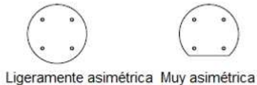
Fig. 10 Pieza ligeramente y muy asimétrica (Boothroyd, 2011)
