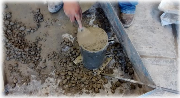
Figura 2.34. Llenado de los moldes con la mezcla de concreto.
