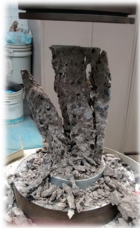
Figura 3.37. Cilindro de la mezcla elaborada de 90% agregados reciclados y 10% agregados vírgenes después de fallar.
