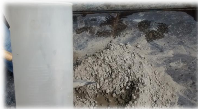
Figura 2.31. Vertido del agua sobre la muestra.
