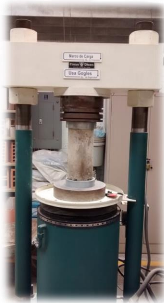
Figura 3.4. Cilindro perfectamente centrado sobre el marco de carga.
