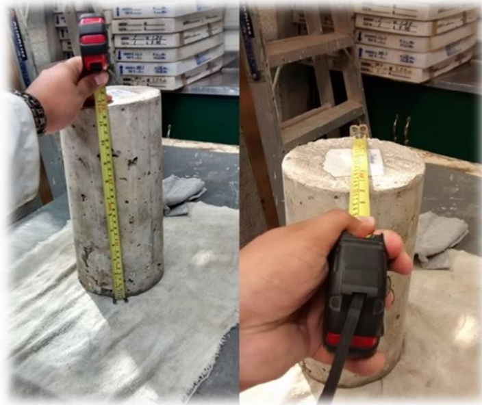
Figura 3.2. Determinación de la altura y diámetro de los cilindros.
