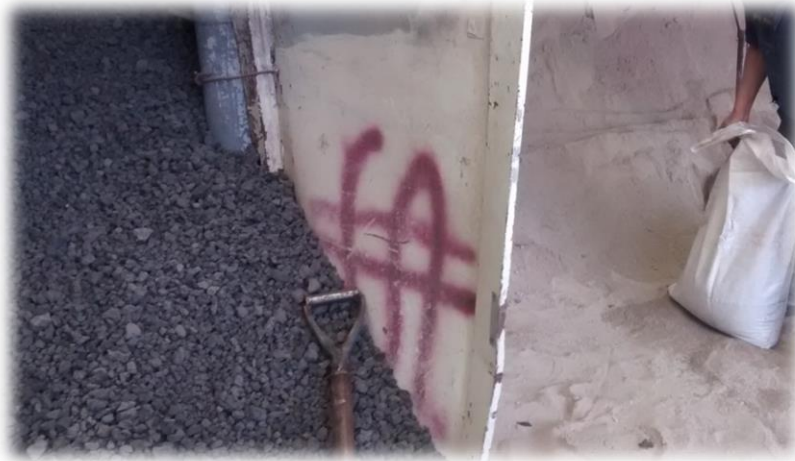
Figura 2.4. Arena y grava vírgenes, Casa de materiales delegación Iztapalapa. Fuente: Elaborado por el autor.
