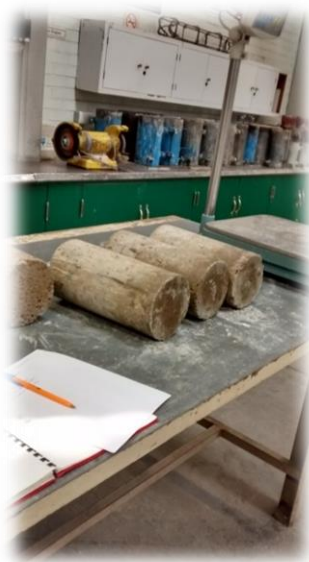
Figura 3.1. Cilindros perdiendo el exceso de humedad antes de obtener su masa.
