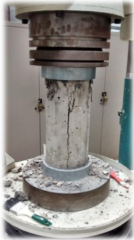
Figura 3.33. Cilindro de la mezcla elaborada de 75% agregados reciclados y 25% agregados vírgenes después de fallar.
