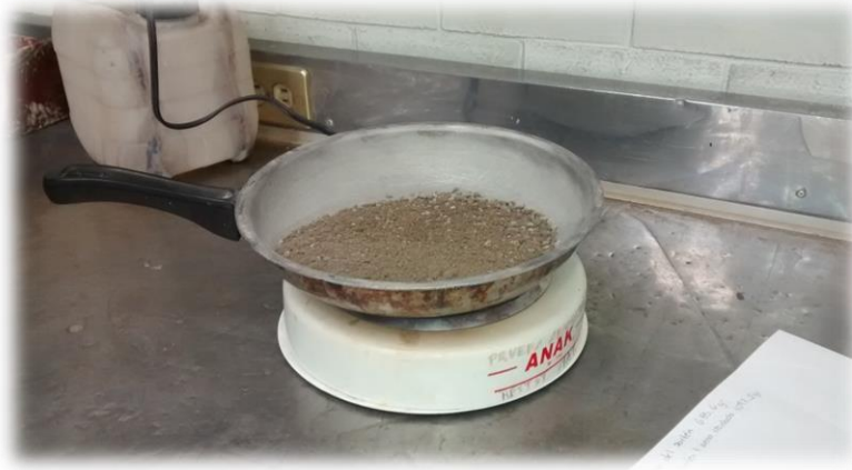
Figura 2.20. Secando la muestra en la parrilla eléctrica.
