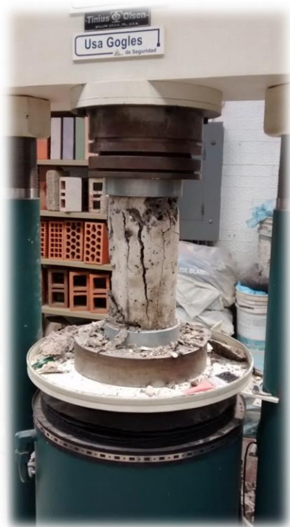
Figura 3.29. Cilindro de la mezcla elaborada de 60% agregados reciclados y 40% agregados vírgenes después de fallar.
