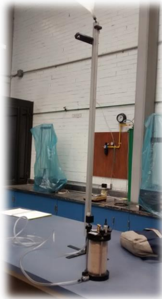
Figura 3.43. Instalación del permeámetro.
