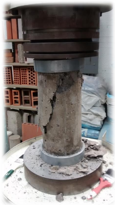
Figura 3.21. Cilindro de la mezcla elaborada de 30% agregados reciclados y 70% agregados vírgenes después de fallar.
