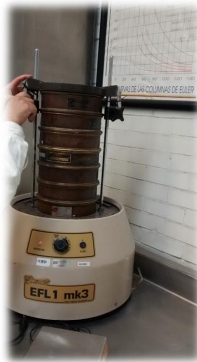
Figura 2.15. Cribas sobre máquina agitadora.
