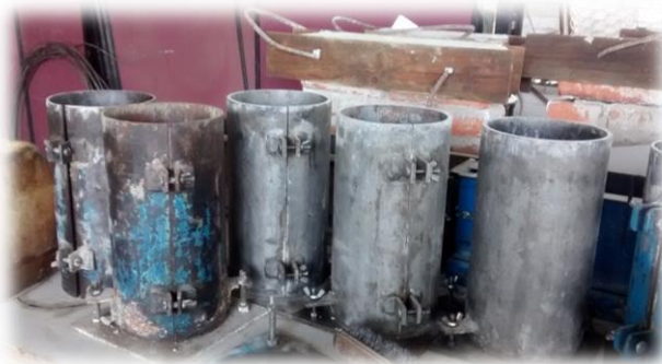
Figura 2.27. Moldes cilíndricos limpios y aceitados.
