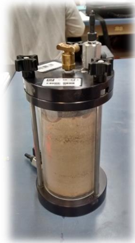
Figura 3.42. Permeámetro lleno con la muestra.
