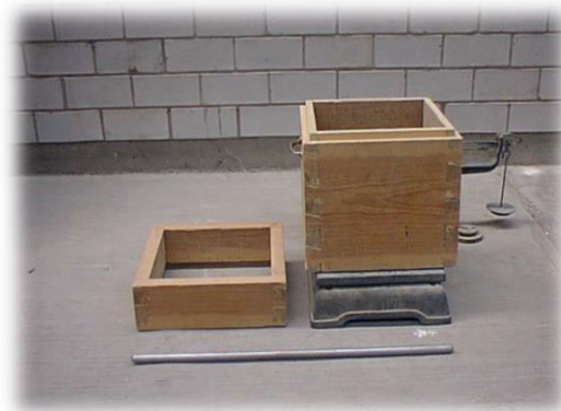
Figura 2.18. Contenedor, marco de enrase y varilla para obtener peso volumétrico.
