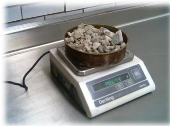
Figura 2.12. Determinación del peso de la muestra.
