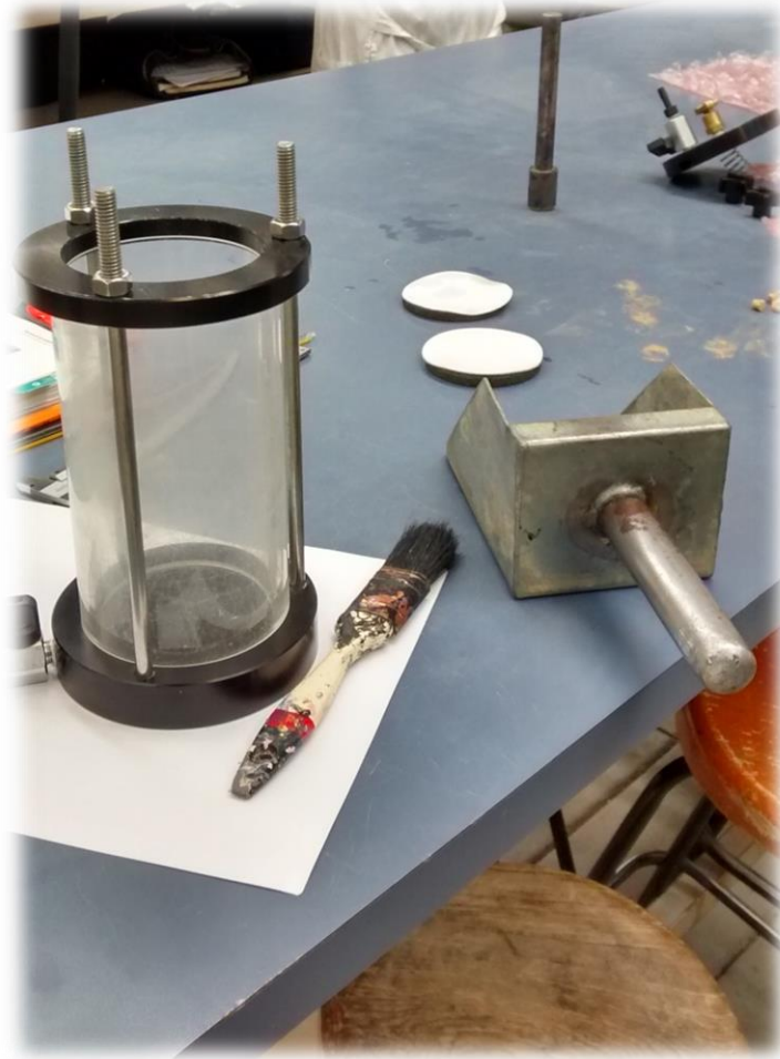
Figura 3.40. Equipo utilizado en la prueba de permeabilidad.
