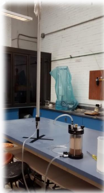
Figura 3.47. Permeámetro instalado, muestra saturándose.
