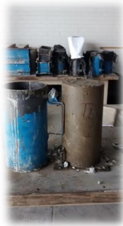
Figura 2.37. Descimbrado de los especímenes.
