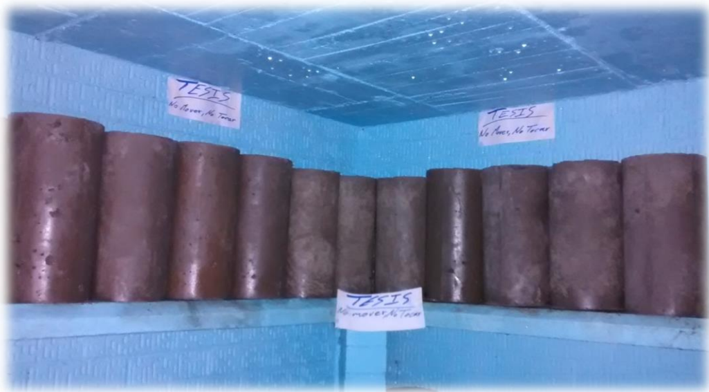
Figura 2.39. Especímenes almacenados en el cuarto húmedo. Fuente: Elaborado por el autor.
