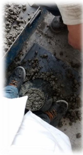
Figura 2.32. Prueba de revenimiento.
