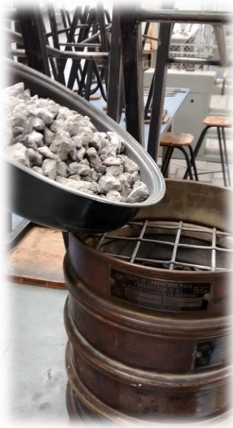
Figura 2.14. Depósito de la muestra sobre las cribas.
