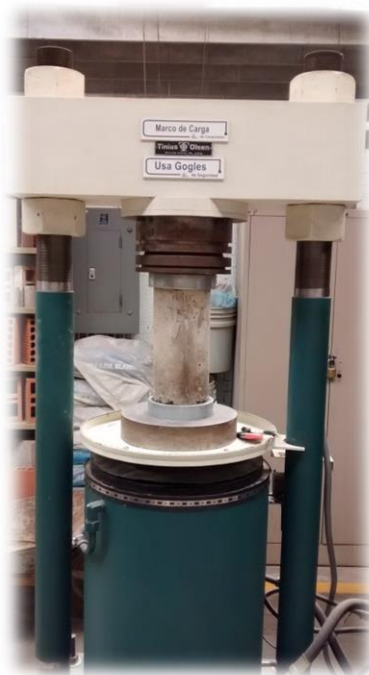
Figura 3.13. Cilindro elaborado únicamente de materiales vírgenes, donde se puede observar un mejor acabado en relación con un cilindro elaborado únicamente de materiales reciclados, como el de la figura 3.12.
