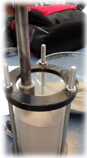
Figura 3.41. Compactación por capas de la muestra de tepetate con el pisón.
