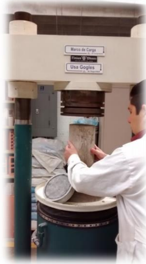
Figura 3.3. Cilindro colocándose en el centro del molde con almohadillas de neopreno.
