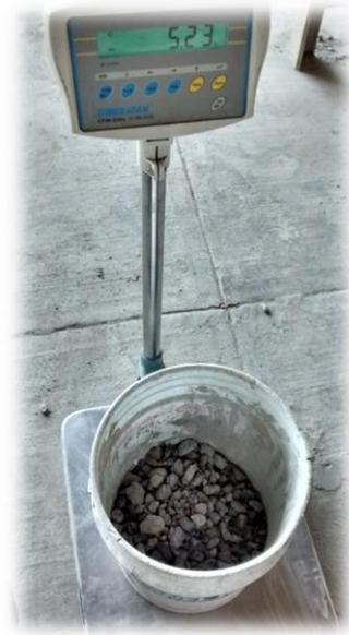
Figura 2.28. Pesado de los materiales para elaborar las mezclas.
