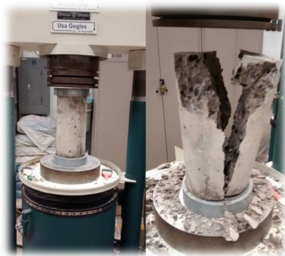
Figura 3.17. Cilindro de la mezcla elaborada de 15% agregados reciclados y 85% agregados vírgenes antes y después de fallar.
