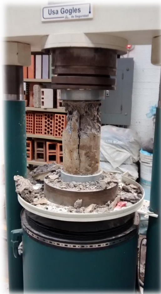
Figura 3.25. Cilindro de la mezcla elaborada de 45% agregados reciclados y 55% agregados vírgenes después de fallar.
