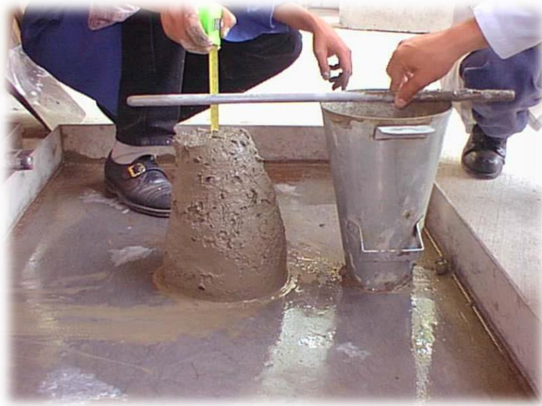
Figura 2.33. Determinación del revenimiento.
