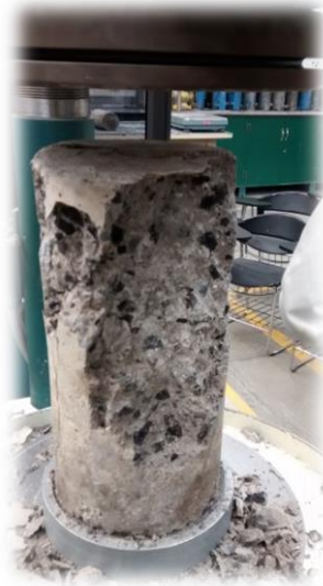
Figura 3.8. Cilindro de la mezcla elaborada en su totalidad por agregados vírgenes después de fallar.
