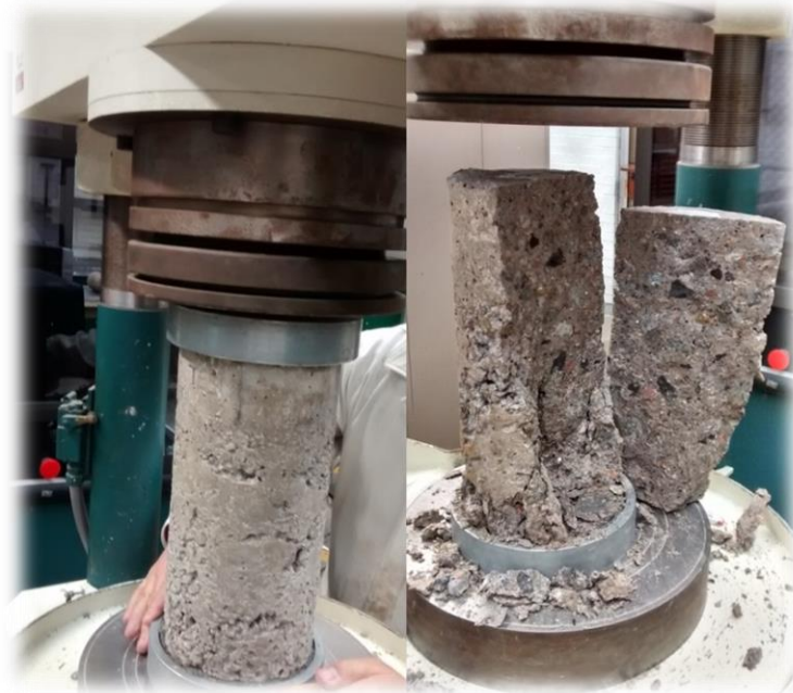
Figura 3.12. Cilindro de la mezcla elaborada en su totalidad por agregados reciclados antes y después de la prueba.
