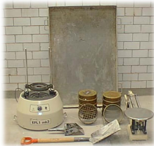
Figura 2.7. Equipo para prueba de granulometría.
