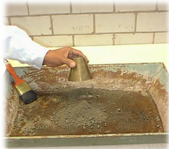
Figura 2.23. Verificación del desmoronamiento.
