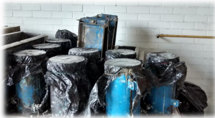
Figura 2.35. Cilindros protegidos contra la evaporación del agua.
