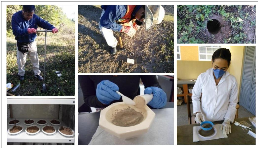
Fig. 3-2. Muestreo y preparación de suelo superficial. a) Colecta de suelo control en áreas verdes, b) Colecta de suelo superficial en áreas verdes, c) Suelo muestreado, d) Secado del suelo en el laboratorio, e) Trituración de muestras de suelo con el mortero, y f) Tamizado de suelo para después introducirlo a cubos de plástico.
