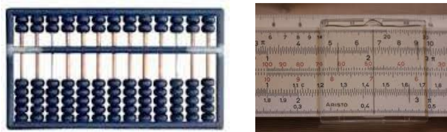
FIG.- 2 ÁBACO Y REGLA DE CÁLCULO
