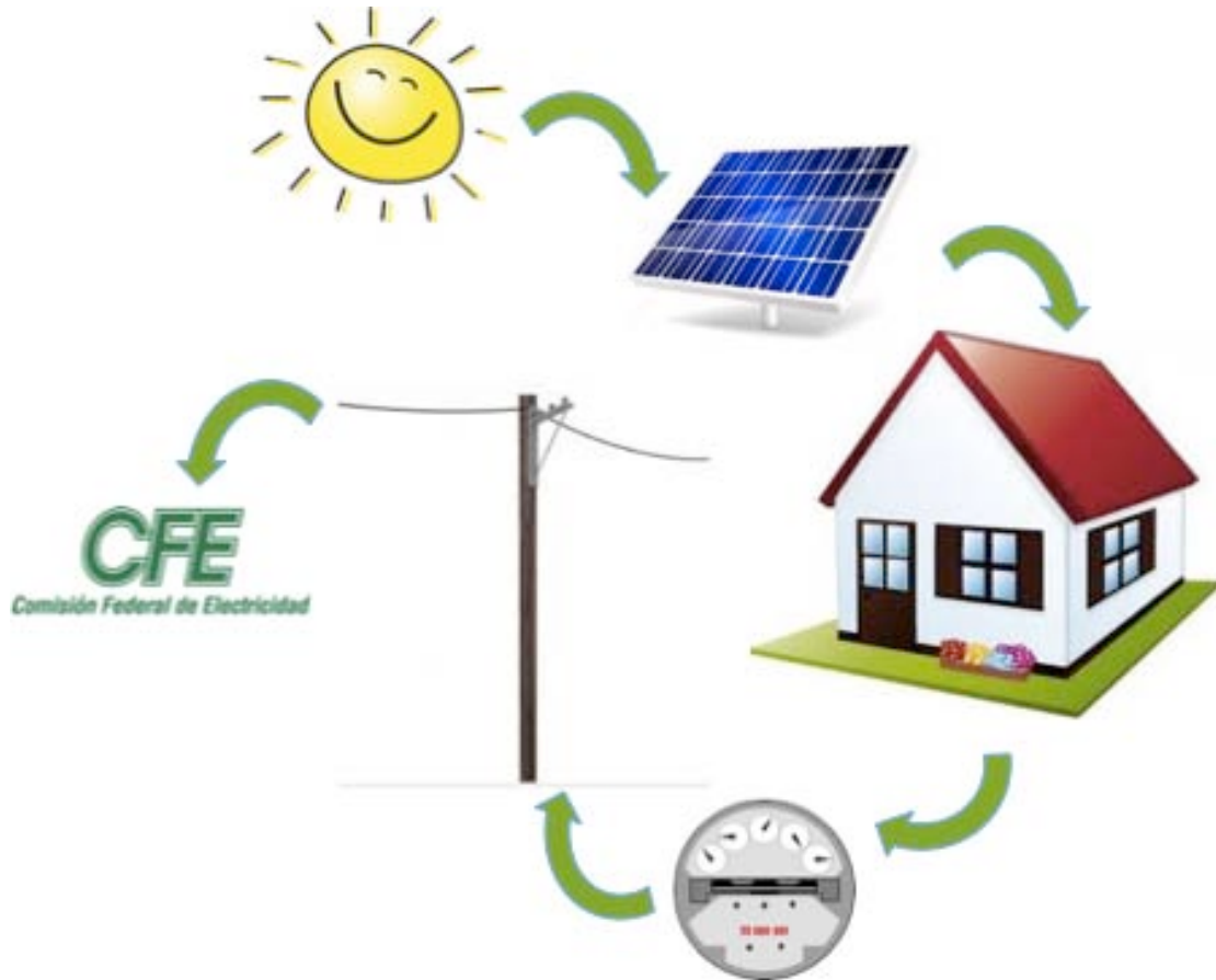
Figura 13 – Esquema de funcionamiento de sistemas de generación interconectados a la red
