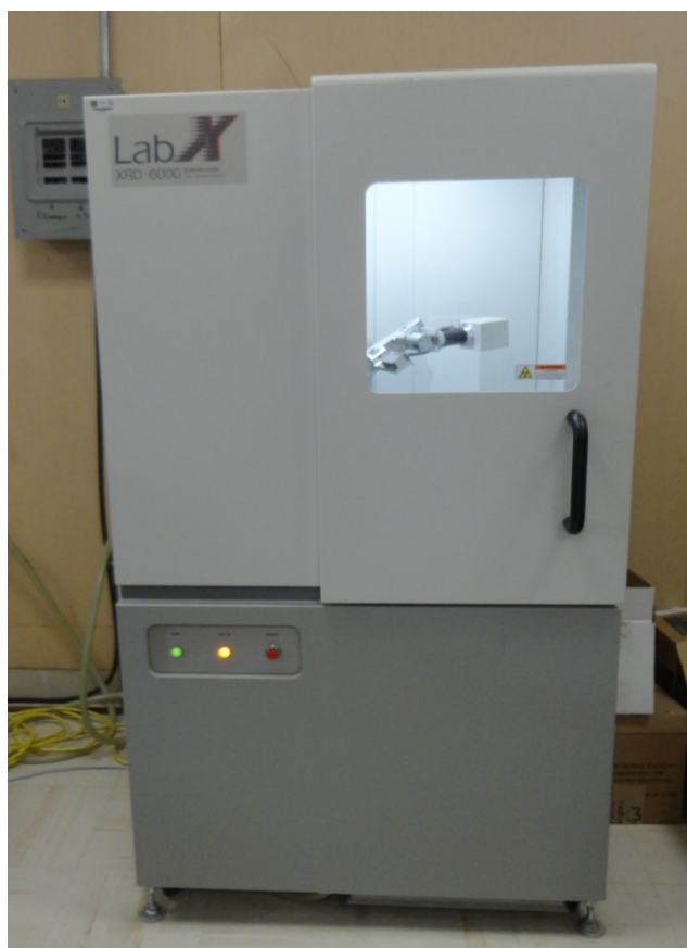
Figura 3.8 Difractómetro Shimadzu X-Ray 6000 tipo Bragg-Brentano, Laboratorio de DRX, Instituto de Geología, UNAM.
