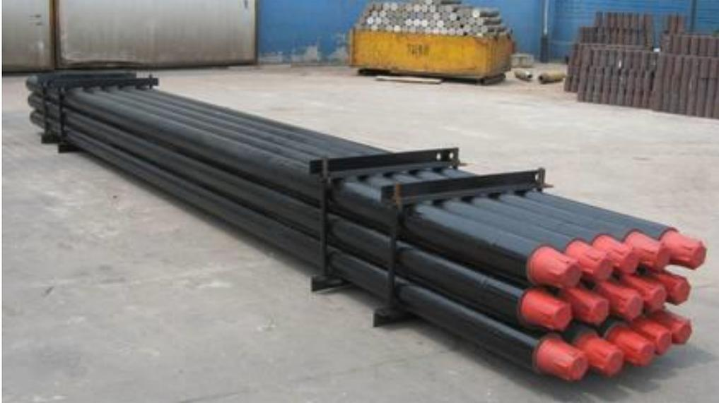
**Figura 56.-** Representación de una tubería (*drill pipe*) usada en la perforación de un pozo geotérmico (Manual de Perforación Schlumberger)
