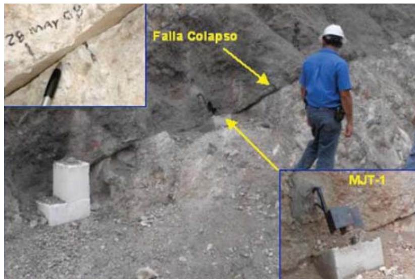
Figura 2. 14 Desplazamiento detectado visualmente el 13 de mayo de 2008 en el camino 9MI. Elevación 395 m y ubicación del medidor de juntas tridireccional MJT-1.
