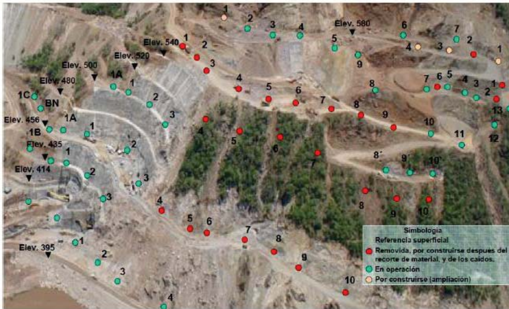
Figura 2. 22 Referencias superficiales instaladas y retiradas en agosto de 2008.
