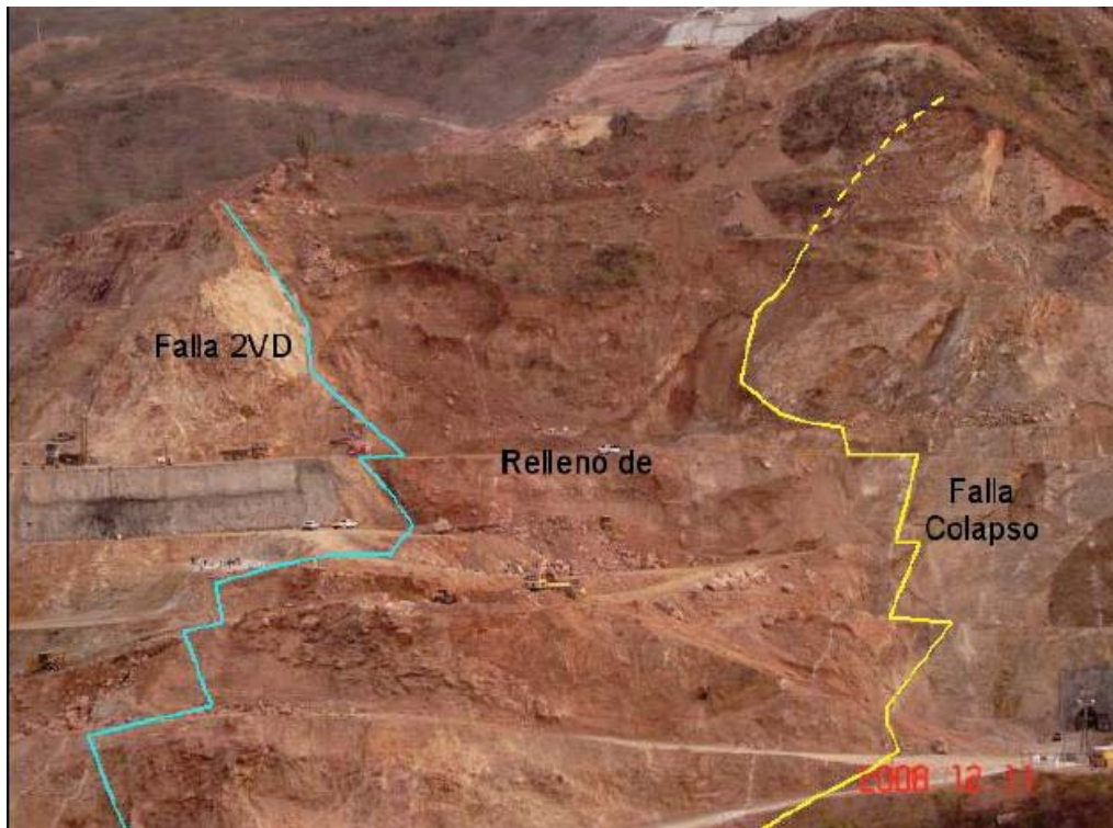
Figura 2. 12 Fosa Limitada por las fallas Colapso y 2VD, rellena por depósitos de talud y material de pumicitas. La base de la fosa consiste en roca muy fracturada. Oxidada y propilitizada.
