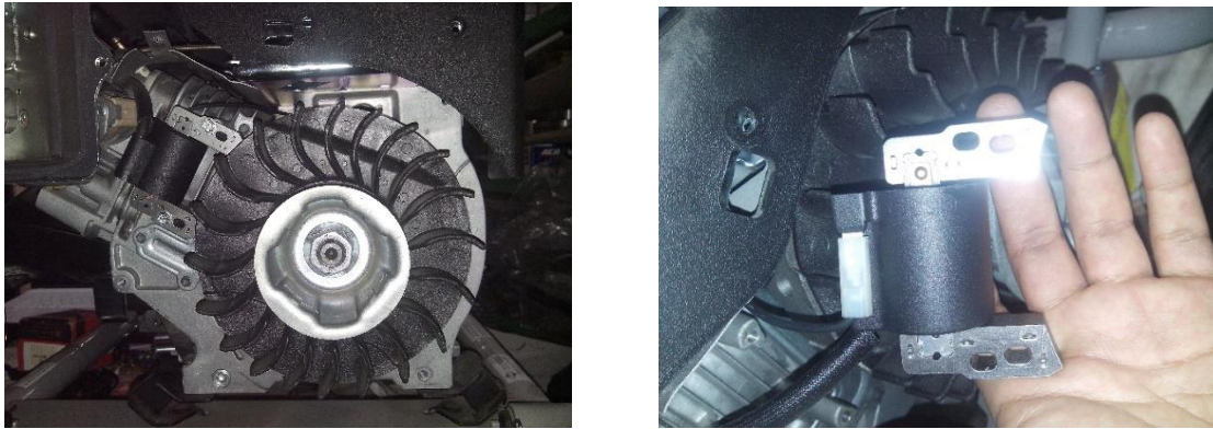
Figura 4.10 Bobina de ignición y su ubicación en el motor.
