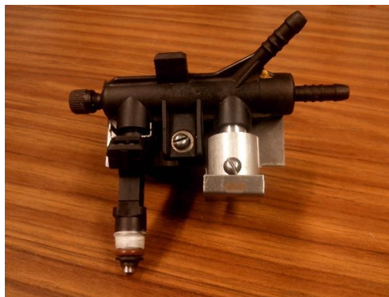
Figura 4.27 Ensamble del inyector junto con las salidas de combustible.
