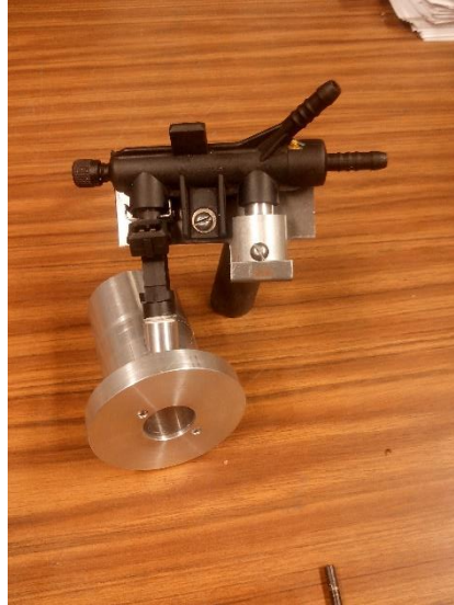
Figura 4.28 Ensamble del inyector por interferencia.
