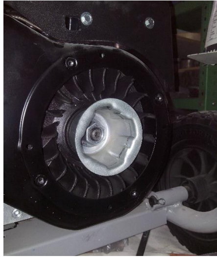
Figura 4.8 Parte posterior del eje del motor.
