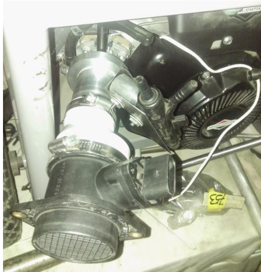
Figura 4.2 implantación final del sensor MAF.
