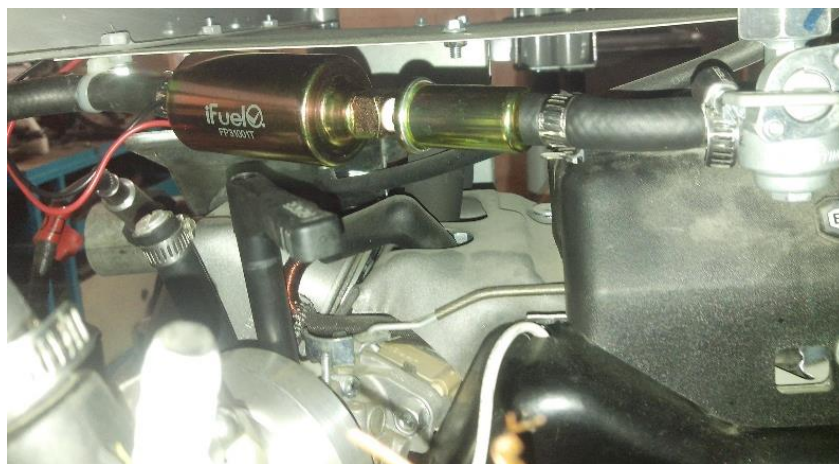
Figura 4.13 Conexiones de la bomba de gasolina.
