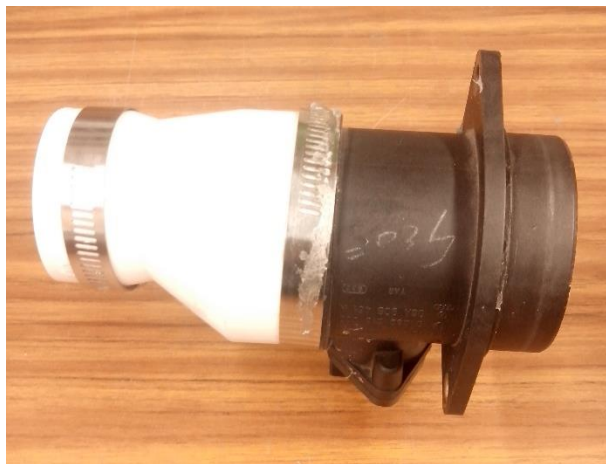
Figura 4.1 Cople de PVC empleado en el sensor MAF.
