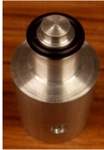
Figura 4.25 Ensamble del tapón y el O-ring.
