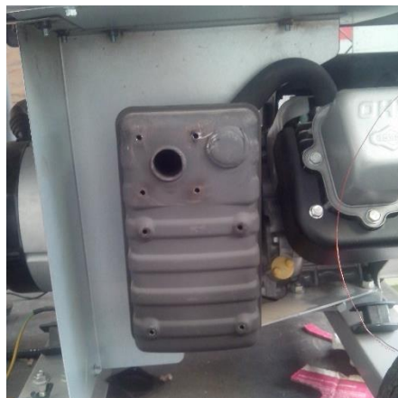
Figura 4.3 Posición ideal para colocar el sensor de oxígeno.
