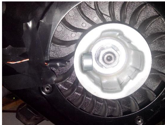
Figura 4.9 Instalación del sensor de efecto hall junto con el imán.
