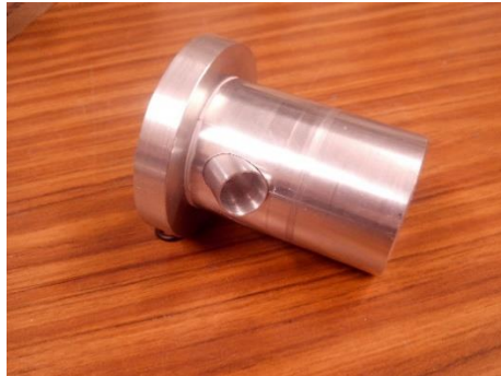
Figura 4.23 Ensamble de base con mezclador.
