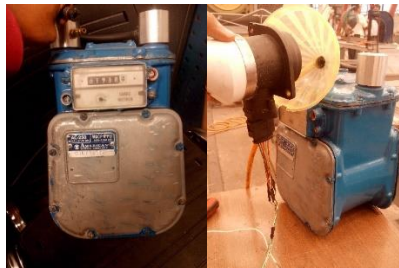
Figura 2.10 implementación física sensor MAF.
