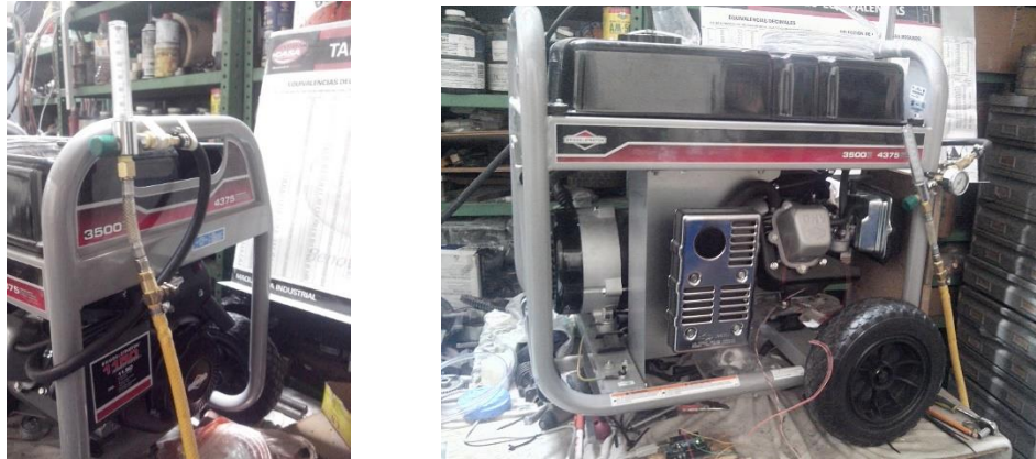
Figura 4.15 Conexiones físicas de mangueras motor dual.
