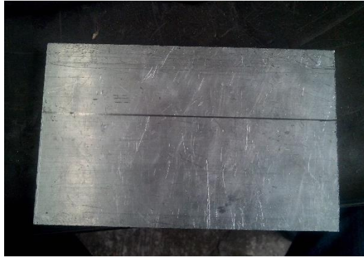
Figura 4.4 Base de aluminio empleada para fijar el sensor de oxígeno.
