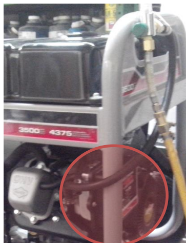
Figura 2.25 Carburador del motor Briggs & Stratton.
