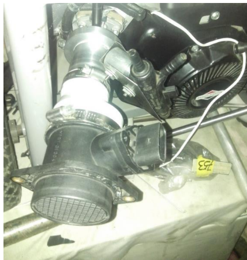
Figura 2.7 Colocación del Sensor MAF.
