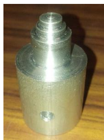
Figura 4.24 Tapón para el riel de inyectores.
