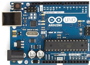
Figura 2.9 Tarjeta de desarrollo Arduino Uno.
