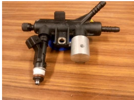
Figura 2.32 Ensamble inyector Bosch NGI2.
