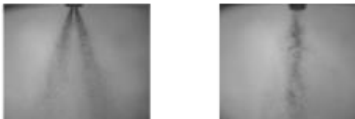
Figura 2.29 Patrón de atomización ideal (izquierda) incorrecto (derecha).
