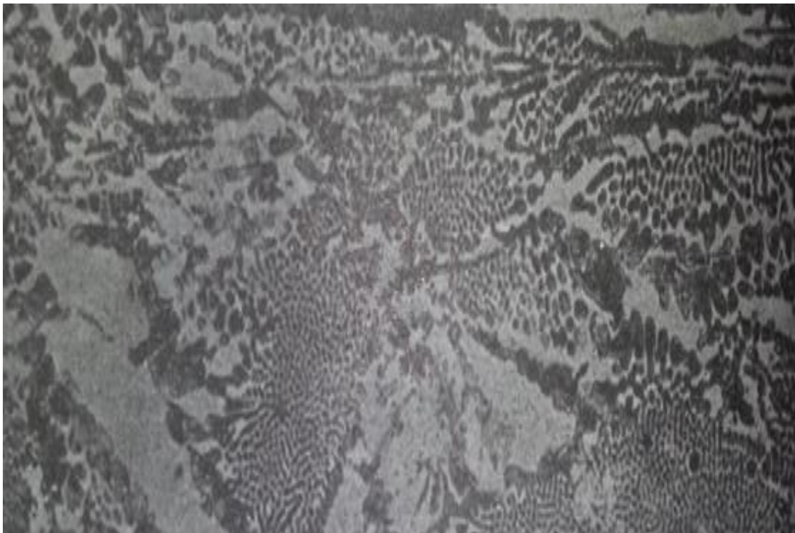
Figura 2. 200X Microestructura de una fundición blanca hipereutética. Se observan importantes masas blancas de cementita hipereutética. También se observan agrupaciones pseudoeutéticas derivadas de la lebedurita que están constituidas por pequeñas partículas negras de perlita sobre un fondo blanco de cementita.
