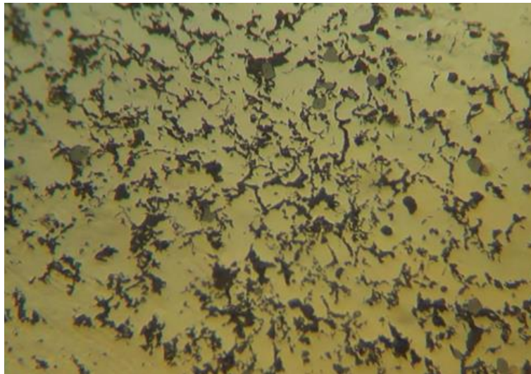
Figura 54. Muestra con un post calentamiento a 450°C a 400X.
