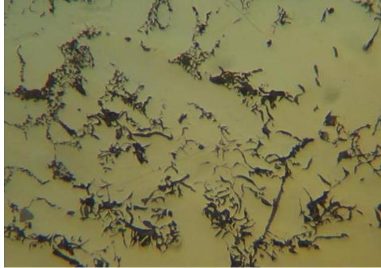
Figura 51. Muestra con post calentamiento a 350°C a 400X.
