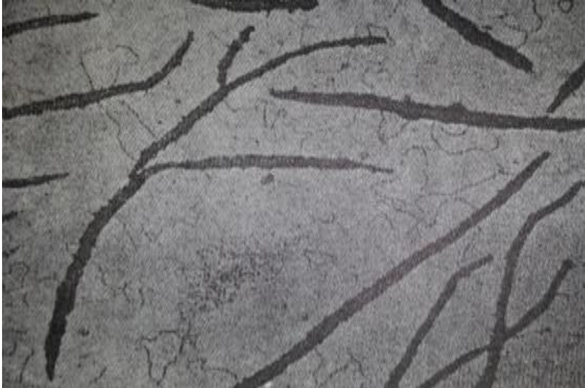
Figura 3. 200X Fundición gris ferrítica. Láminas de grafito sobre un fondo blanco de cristales de ferrita.
