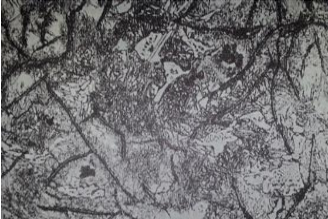
Figura 4. 100X Microestructura de una fundición gris Martensítica. Se ven láminas de grafito sobre fondo oscuro con agujas de Martensita. Entre la Martensita quedan algunos núcleos blancos de cementita.
