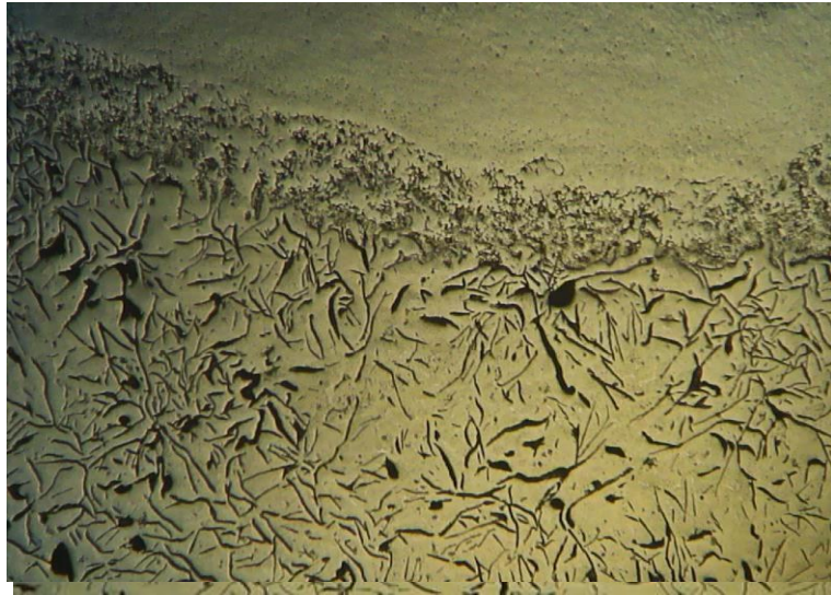
Figura 49. Muestra con post calentamiento a 350°C a 50X.
