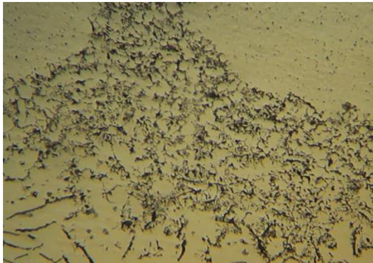
Figura 50. Muestra con post calentamiento a 350°C a 100X.
