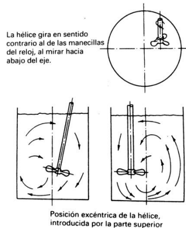
Figura 0.9. Patrón de flujo para una hélice en posición angular y excéntrica sin deflectores
