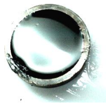
Figura 2.17. Anillo con asfalto
