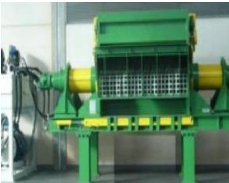
Los trituradores son máquinas que normalmente trabajan con parillas que van desde los 20mm hasta los 100mm, estos equipos ofrecen la posibilidad de intercambiar la parilla estandar con otras de diferentes tamaños, todo depende del tamaño de material que se quiere obtener.
