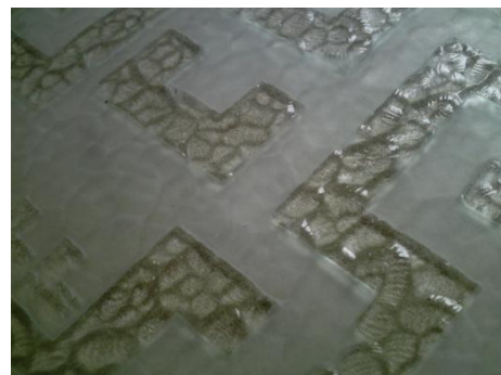
3. Placa limpia, se han retirado las mascarillas y eliminado la arena adherida. Se pueden observar los desniveles en la textura producto del desbaste del Sand-blast.
