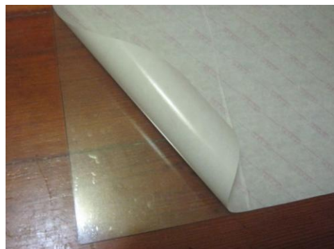
4. Volteamos el vidrio 180° y cortamos los excedentes de la película adherible con una cuchilla.
