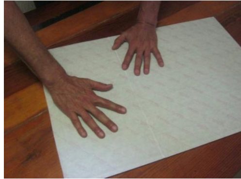
5. Procedemos a desprender la segunda hoja protectora. Observamos cómo la superficie del vidrio base, queda recubierta por la película adherible de doble cara.
