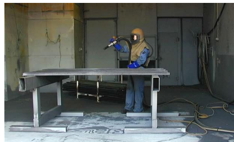
Aplicación de Sand-Blast en un taller especializado, se puede maniobrar en grandes superficies y maquilar piezas de gran tamaño.
