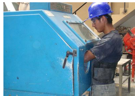
Demostración del uso de la cabina de arenado.
