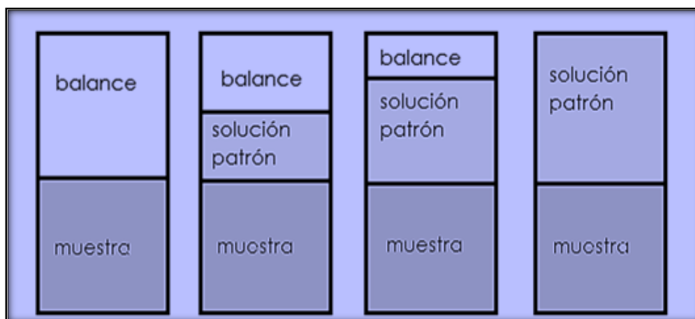
Figura 11 Representación esquemática del método del estándar adicionado (Brown, 2011).
