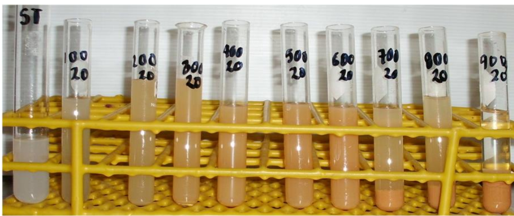
Figura 23. Pruebas con 20ppm de biopolímero a diferentes concentraciones de sal inorgánica (100 a 900ppm) en tubos de ensayo.
