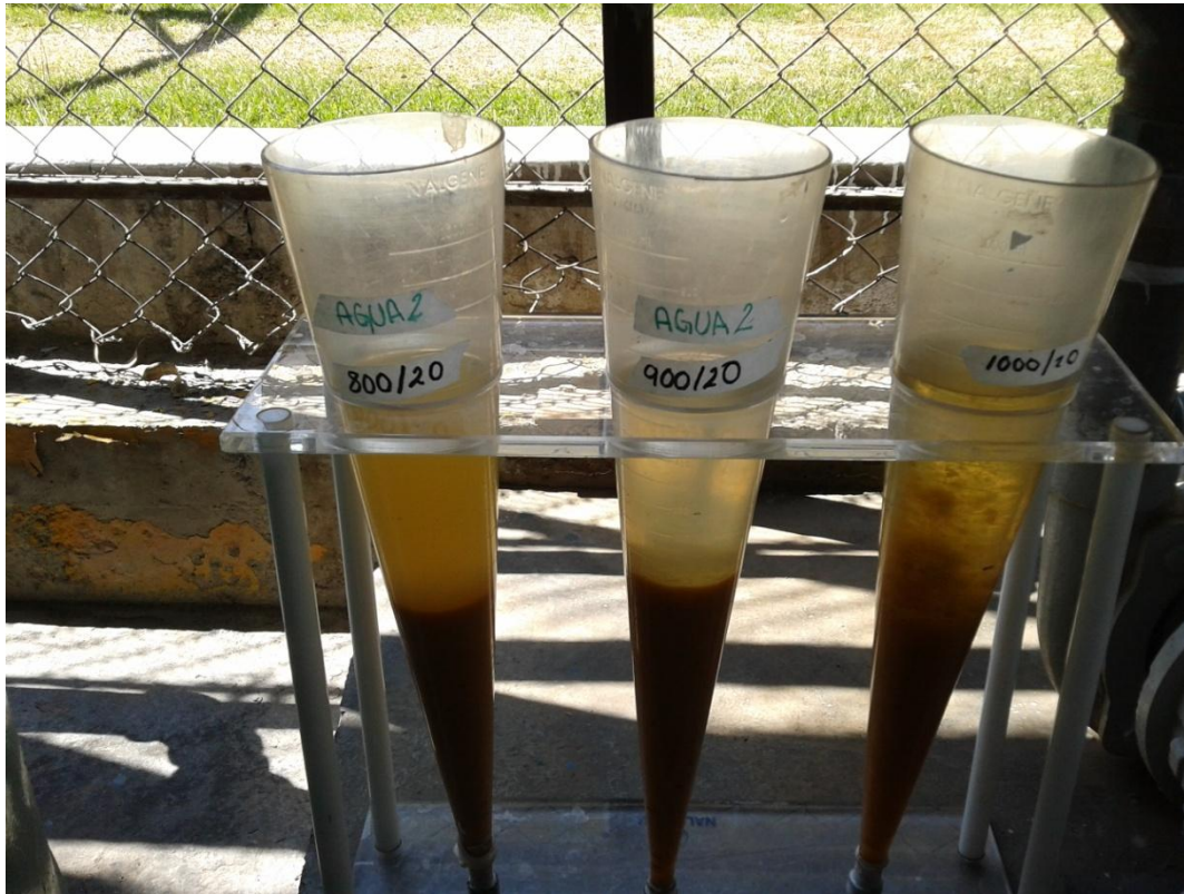
Figura 26. Efluente tratado con a)800, b)900 y c)1000 ppm de sal inorgánica y 20ppm del biopolímero.
