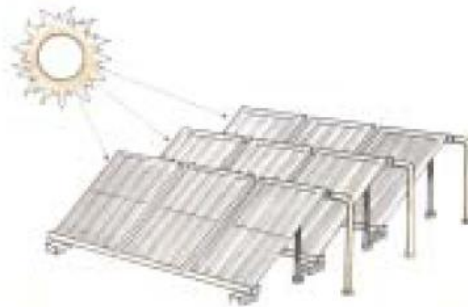
Figura 6. Reactor solar sin concentración (Malato et al. , 2007).
