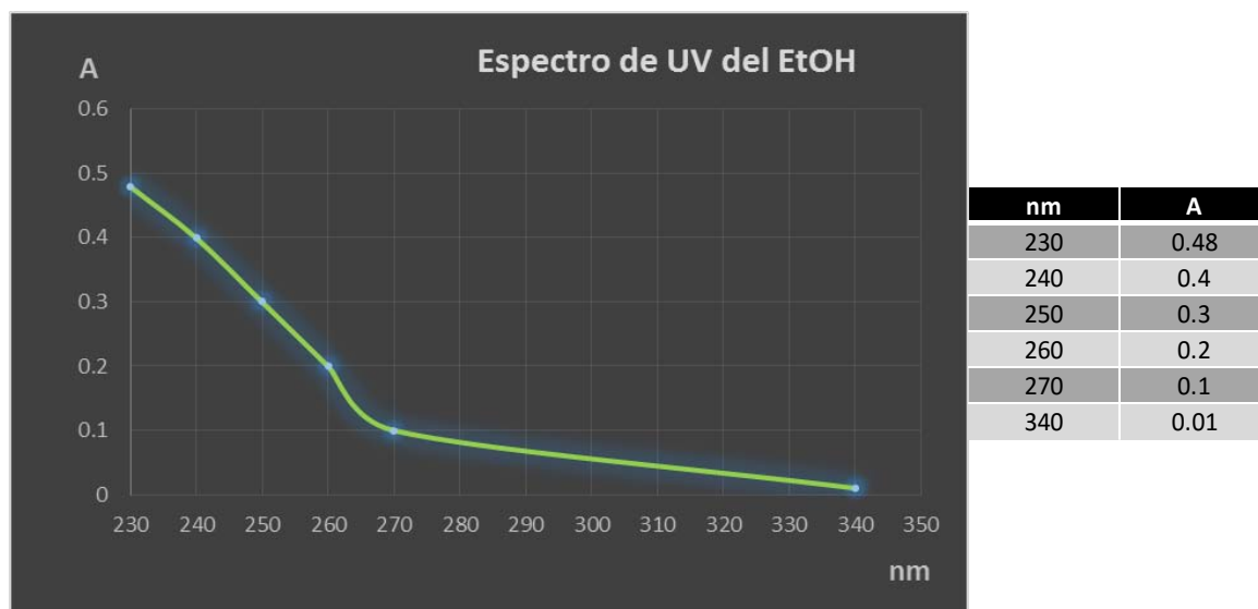
Figura 6. Espectro de UV del EtOH 96° G.L. con base a los límites máximos de absorción que permite la BP y USP.
