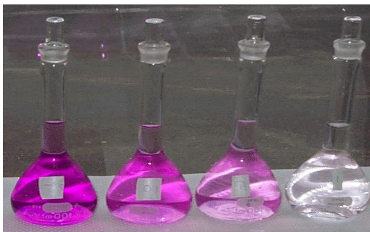
Figura 10. Resultado de la oxidación de aldehídos e impurezas orgánicas presentes en el EtOH. Conforme pasa el tiempo la cantidad de \text{KMnO}_4 disminuye.
