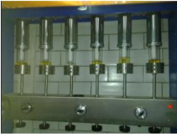
**Figura A.2.13 Determinación de % de grasa por el método de Goldfish**
