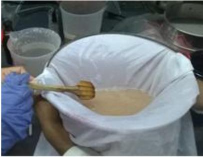
**Figura A.2.7 Filtrado de las harinas desmineralizadas**
