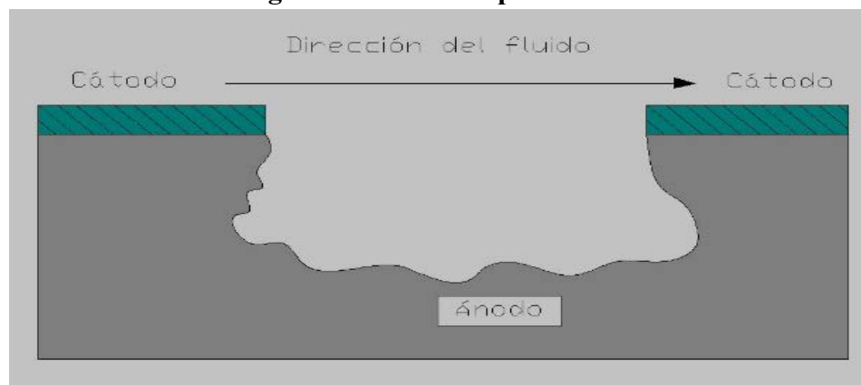
Figura 3: Corrosión por erosión
