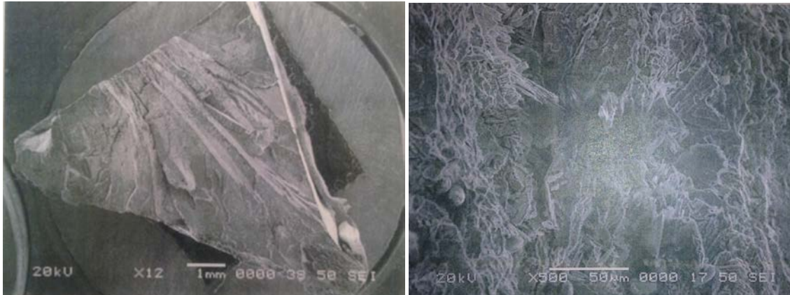
Figura 16 fractura de soldadura
