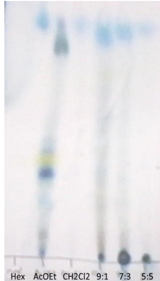
**Fig. 12** Análisis de la complejidad molecular por CCF de la separación por CLV. 9:1, 7:3 y 5:5 corresponden a fases de CH<sub>2</sub>Cl<sub>2</sub>-MeOH con esas proporciones
