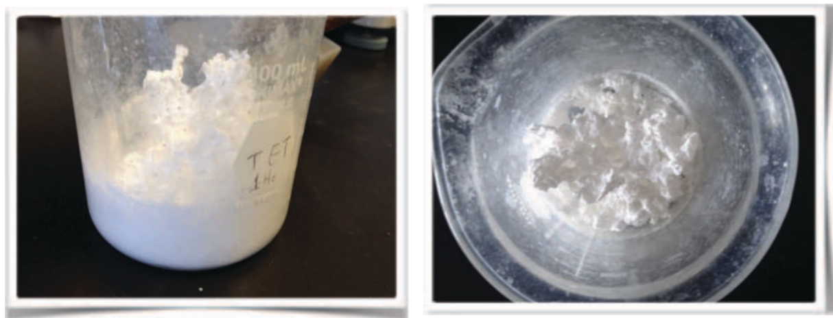
Figura 3. Imagen lateral y superior del vaso de precipitados que contiene el producto sintetizado ( Y_2O_3:Yb^{3+}/Tm^{3+}/Ho^{3+} ).
