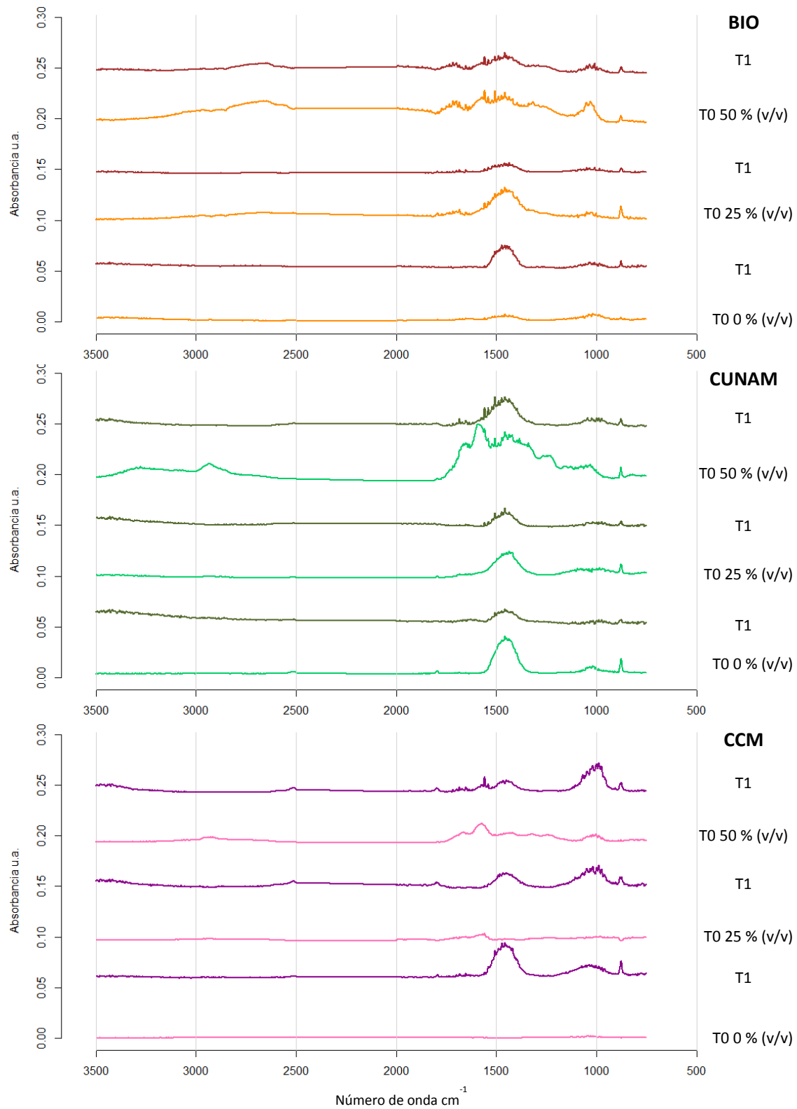
Figura 25. Espectrogramas FT-IR correspondientes a los diferentes tratamientos del SOLONCHAK. De abajo hacia arriba se observan los diferentes tipos de mejoradores (CCM, CUNAM, BIO, respectivamente) y las combinaciones de las diferentes dosis en T0 y T1.
