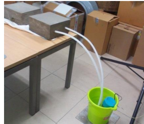
Imagen 46. Prueba de la circulación del agua con la bomba. Fuente: Autoría propia, 2014.
