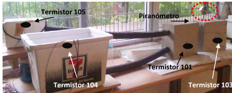
Imagen 53. Localización de los termistores en el experimento en el laboratorio. Fuente: Autoría propia, 2014.
