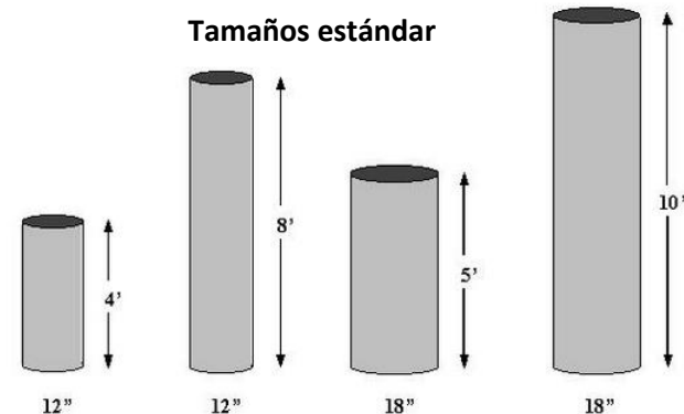
Figura 8. Tamaño de los tubos cilíndricos. Fuente: Hopper, 2014.
