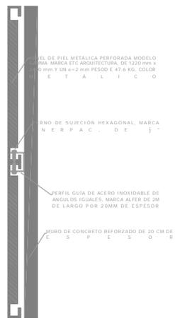
DETALLE EN PLANTA UNIÓN PANEL PERFORADO
