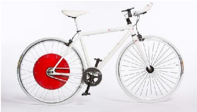
Imagen 8 Rueda Copenhague adaptada a bicicleta Extraída de http://www.abc.es/ciencia/20140901/abci-rueda-convierte-bicicleta-comun-201409011100.html
