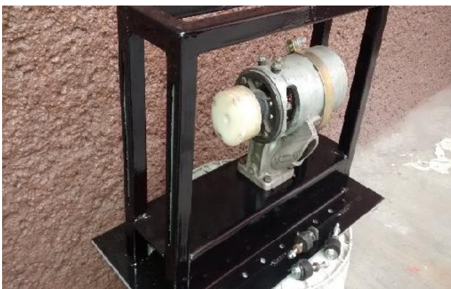
Fotografía 7. Acoplamiento mecánico unido al generador.
