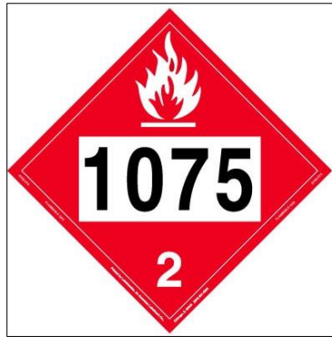
Figura 5.2 – Cartel de identificación correspondiente a Gas L.P. (GLP)
