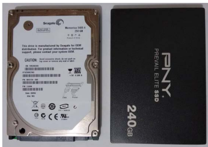
Ilustración 1.7: Unidades de almacenamiento masivo empleadas por las miniPC: Disco duro rígido (HDD) y disco duro de estado sólido (SSD) ambos de 2.5”
