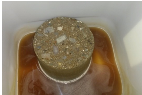
Imagen 14. Concreto celular reaccionando con el peróxido de hidrógeno
