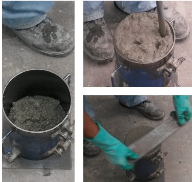
Imagen 8. Procedimiento de llenado de los cilindros
