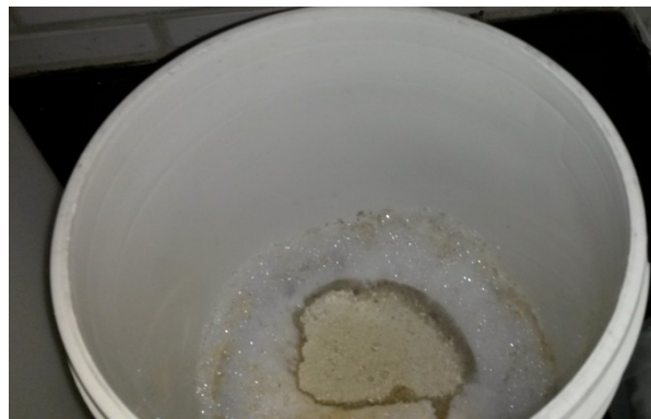
Imagen 14. Concreto celular reaccionando con el peróxido de hidrógeno
