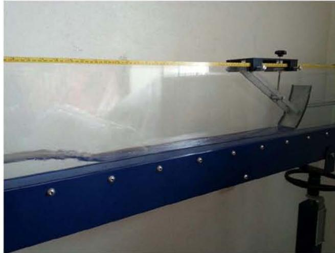
Figura 17. Imagen de las prácticas de laboratorio en el canal tipo Armfield para los perfiles de flujo
