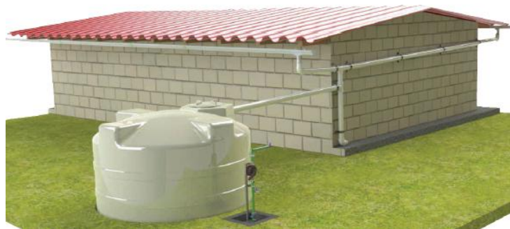
Figura 2.2 Sistema de captación pluvial para viviendas ubicadas en comunidades rurales.
