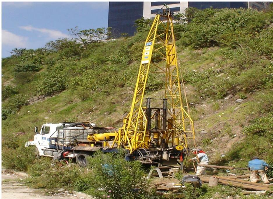
Figura 10.- Sondeo de Penetración Estándar SPT – 3.
