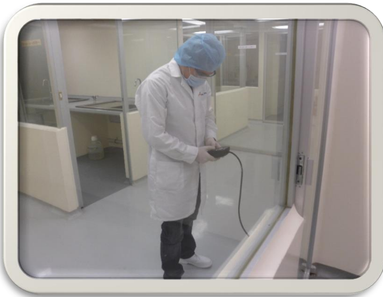
Imagen 5. Medición de presión diferencial en áreas de producción de los Laboratorios Farmacéuticos Zaragoza.
