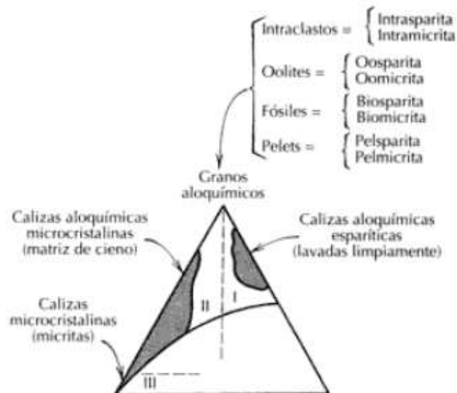
Figura 1.24. Clasificación de las calizas (Folk, R. L 1959, Practical petrographic classification of limestones. Bulletin of the American Association of petroleum Geologist, vols. 43, pags.1-38). Las caliza tipo 1 constan de una mezcla de constituyentes aloquímicos y cemento de calcita espática; las de tipo 2 constituyen un porcentaje variable de granos aloquímicos en una matriz microcristalina y las de tipo 3 están formadas por una matriz de calcita microcristalina.
