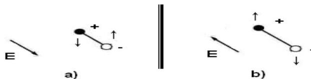
**Figura 2.25. Enlace polar comprimido a), enlace polar estirado b) por efecto de un campo eléctrico, dependiendo de la dirección de este.**
