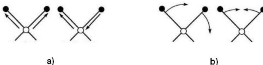
**Figura 2.26. Vibraciones por tensión o estiramiento a) y vibraciones por flexión b).**
