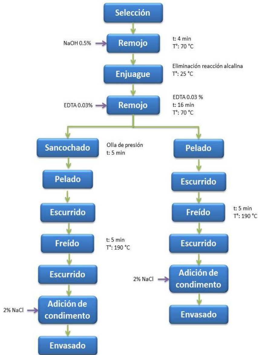
Figura 8. Línea de flujo propuesta para la elaboración de maíz frito tipo "botana" (Hurtado, 2001).
