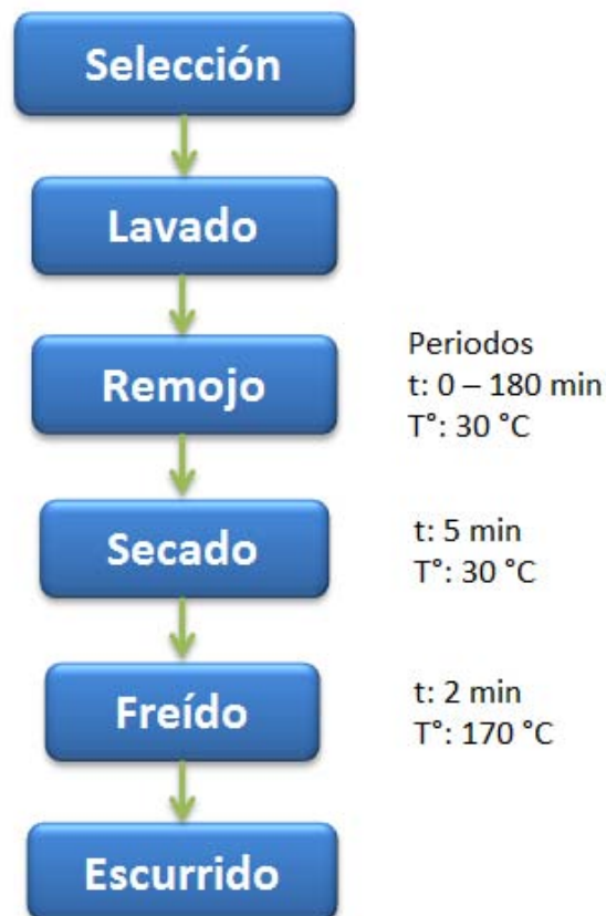
Figura 9. Línea de flujo para la elaboración de frijoles verdes fritos (moon dal) (Holikar y col., 2005)
