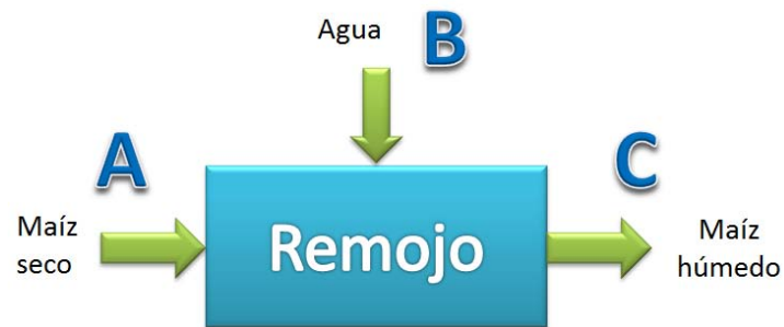
Figura 21. Balance de materia para determinar el porcentaje de agua absorbida por el grano durante el remojo.
