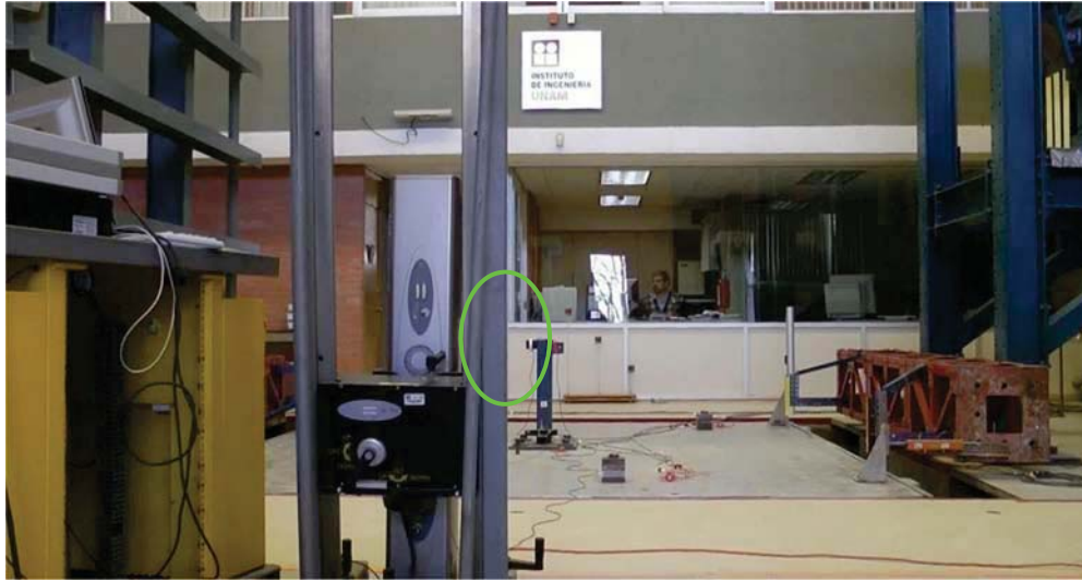
Fig B.4 Mesa Vibradora del Instituto de Ingeniería de la UNAM con la estructura del punto objetivo
