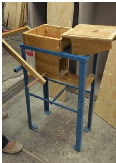
Figura 47. Máquina moldeadora de ladrillos
