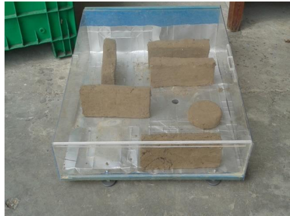
Figura 60. Secado de ladrillos dentro del secador solar
