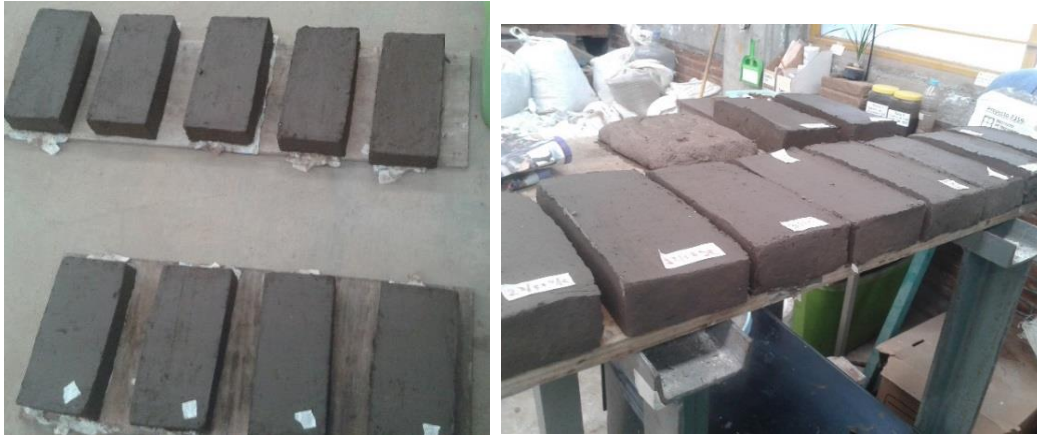
Figura 89. Acondicionamiento de ladrillos en un sitio con condiciones similares
