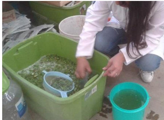
Figura 45. Extracción de la mezcla agua-mucílago
