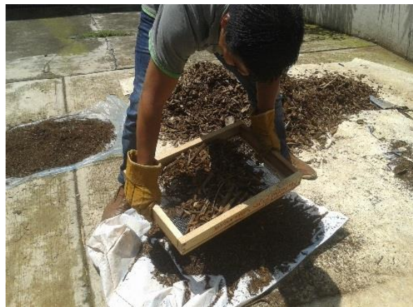
Figura 35. Cribado de residuos de tala
