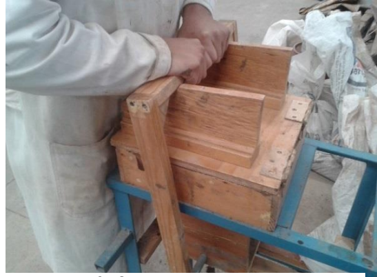
Figura 56. Compactación de la mezcla
