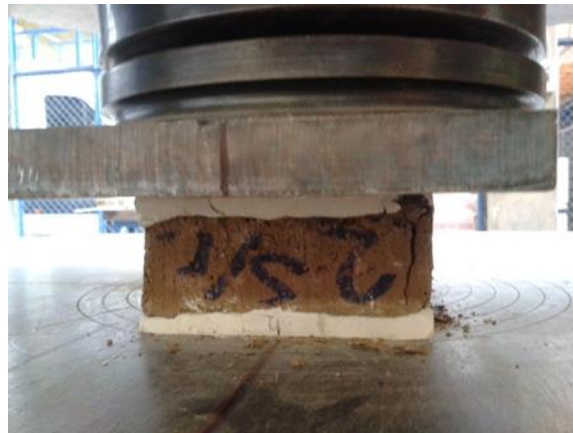
Figura 64. Momento de falla en el espécimen
