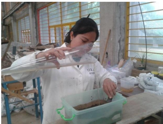
Figura 81. Adición del mucílago de nopal previamente medido
