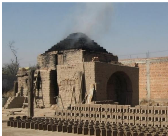
Figura 4. Emisión de GEI de una ladrillera artesanal en operación
