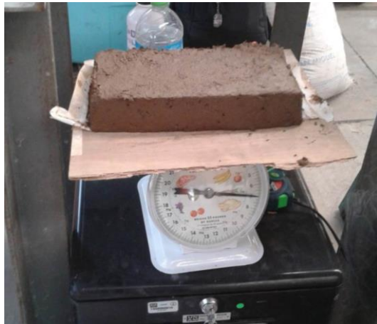
Figura 57. Pesaje de ladrillos inmediato a su fabricación
