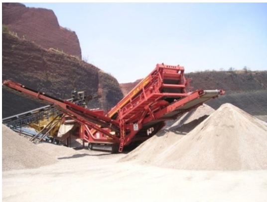
Figura 33. Trituración y separación granulométrica
