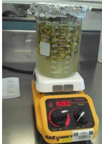
Figura 42. Extracción de mucílago mediante el hervido de los nopales
