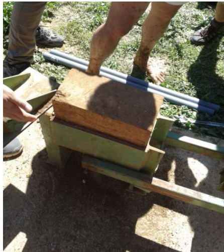
Figura 18. Fabricación de Bloques de Tierra Comprimida Fuente: Propia.
