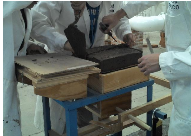
Figura 88. Extracción individual de ladrillos
