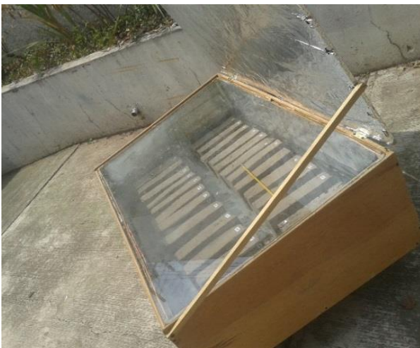
Figura 92. Introducción de ladrillos al secador
