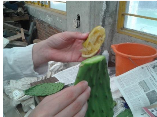
Figura 39. Curado con ácido cítrico
