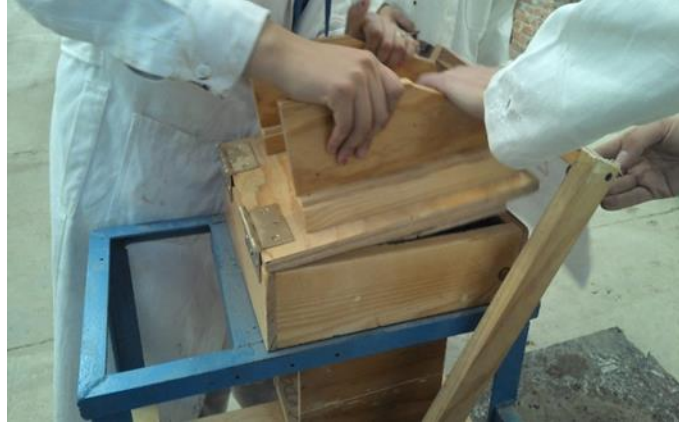
Figura 86. Compactación de los ladrillos en la máquina moldeadora de ladrillos
