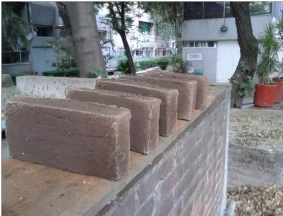
Figura 59. Secado de ladrillos al aire libre
