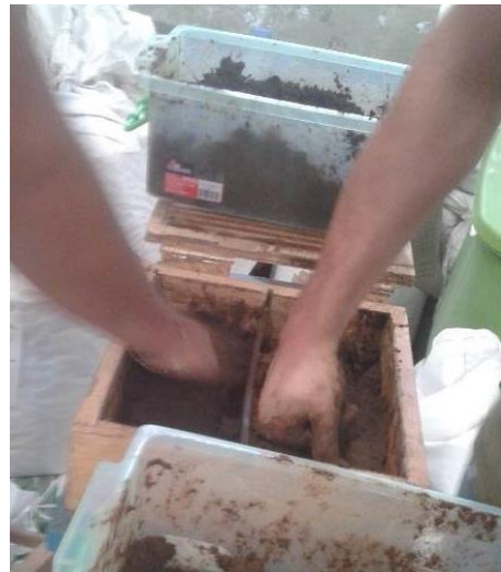
Figura 84. Acomodo y compactación manual de la mezcla
