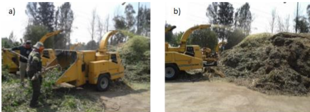
Figura 34. Trituración mecánica de residuos maderables
