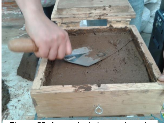
Figura 55. Acomodo de la mezcla en la máquina moldeadora
