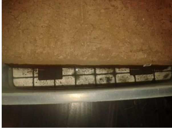
Figura 67. Depósito del ladrillo de prueba sobre las barras metálicas
