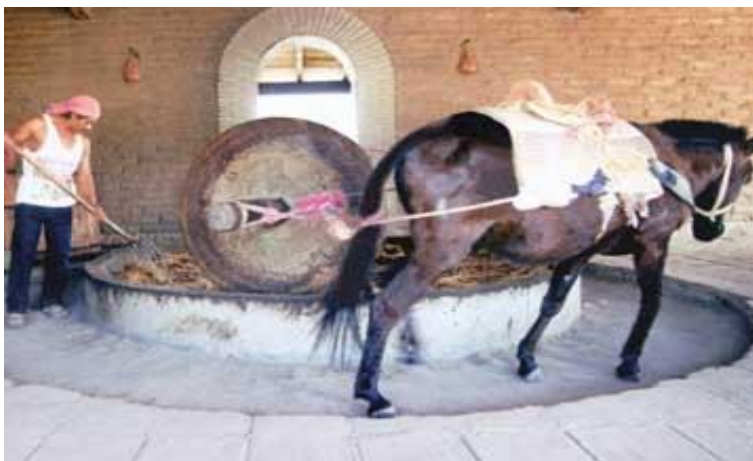
Figura 1.5. Molienda, Molino tipo chileno.
