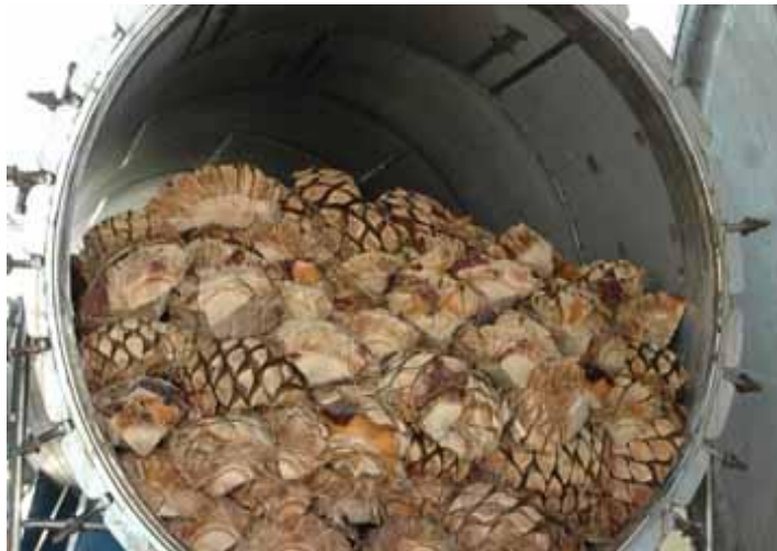
Figura 1.8. Maguey horneado en autoclave
