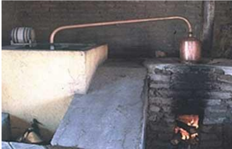
Figura 1.7. Alambique de cobre
