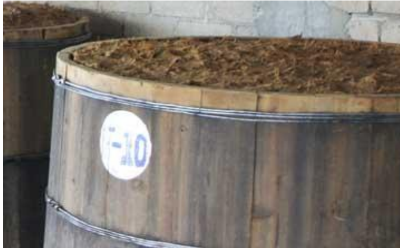
Figura 1.6 . Fermentación del mosto en tinas de madera
