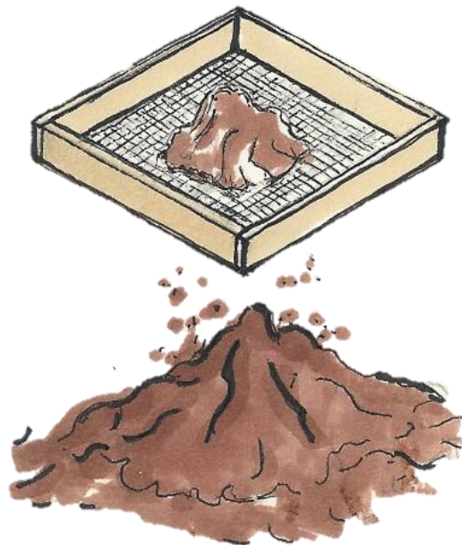
Fig. 23 En acabados es muy importante colar la tierra, esto nos asegurará un resultado fino y de calidad. Imagen: De la autora.
