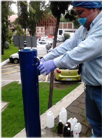
Ilustración 10. Toma de muestras para análisis de calidad del agua en Edificios 1, 5, 7, 13 y Torre de Ingeniería: bebedero de PUMAGUA, afuera del Edificio 5. FUENTE: Elaboración propia.
